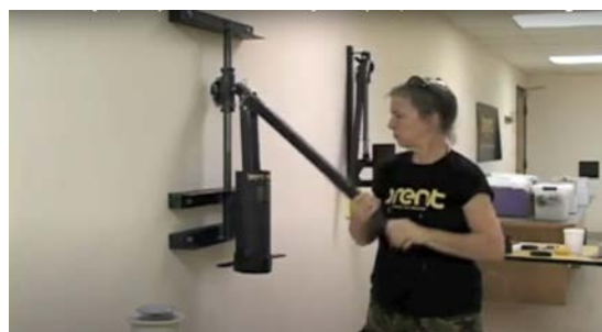
Figura 87 – Dorothy trabalhando com extrusora de cerâmica
