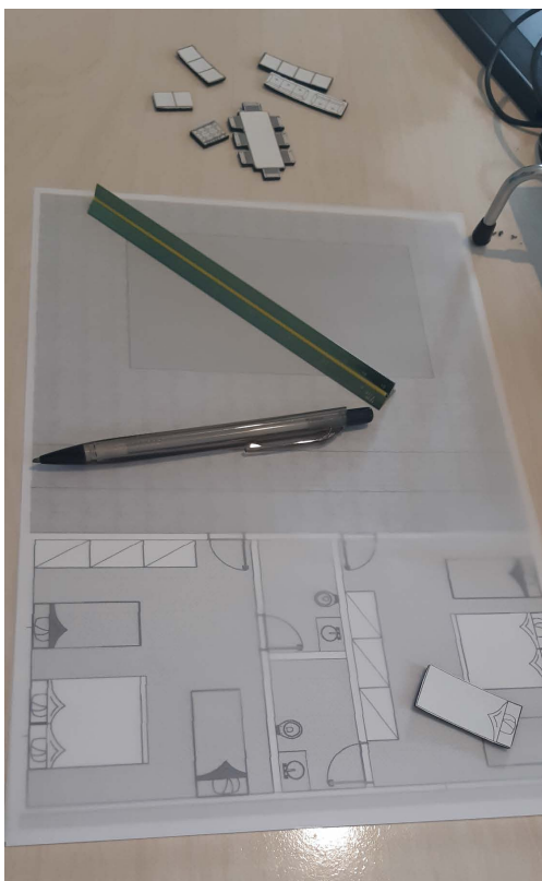
Figura 107 – Estudo preliminar de projeto com blocos de móveis em escala
