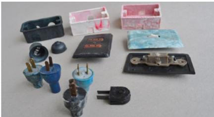
Figura 60 - Componentes Elétricos Fabricados pelo Método de Injeção de Produção Caseira, com Plásticos de Várias Procedências
