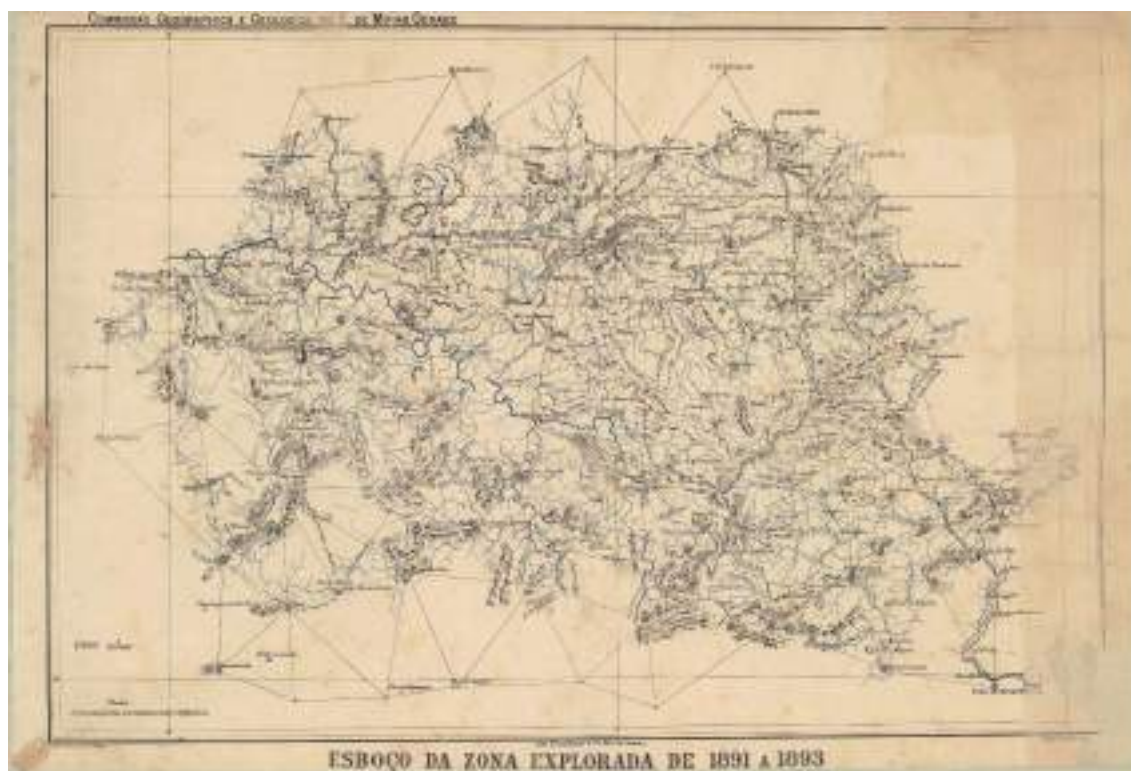
Fig. 78 - Mapa - esboço da zona explorada de 1891 a 1893 - comissão geográfica e geológica de Minas Gerais, usando a triangulação como forma de dar precisão geográfica ao dado. Fonte APM
