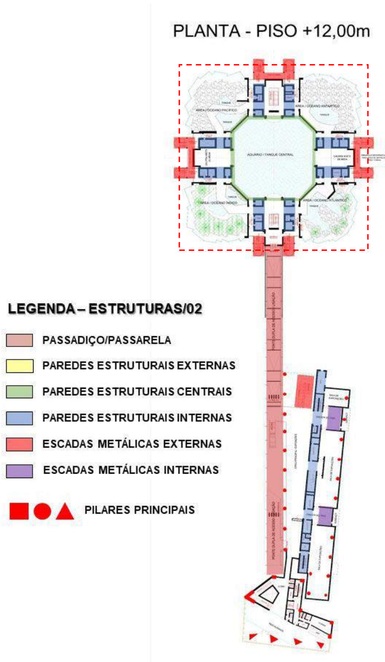
Figura 147: Planta do Oceanário de Lisboa – piso +12,00m – estruturas de ligação entre os edifícios do conjunto
