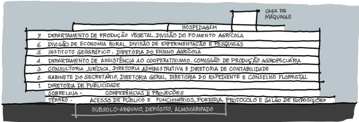
Figura 4-21 – Corte esquemático do Palácio da Agricultura com seus usos planejados para o futuro – Desenho nosso. Fonte: (NIEMEYER, et al., 1952 p. 18)
