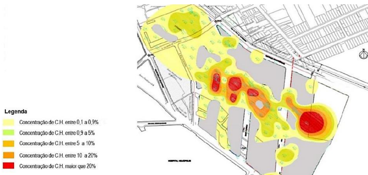
Figura 79 — Investigação ambiental detalhada e Avaliação de risco à saúde humana para o Lote 01, em investigação do solo e águas subterrâneas, em atendimento à CETESB. Fonte: Edital (2018, p. 82).
