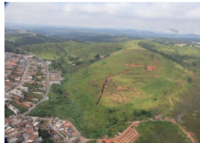
Figura 3 – Ferraz de Vasconcelos, Jardim Ipanema, junto ao limite com São Paulo. A enorme erosão do tipo ravina e o terreno com solo exposto contribuem com o assoreamento dos corpos d’água próximos.
