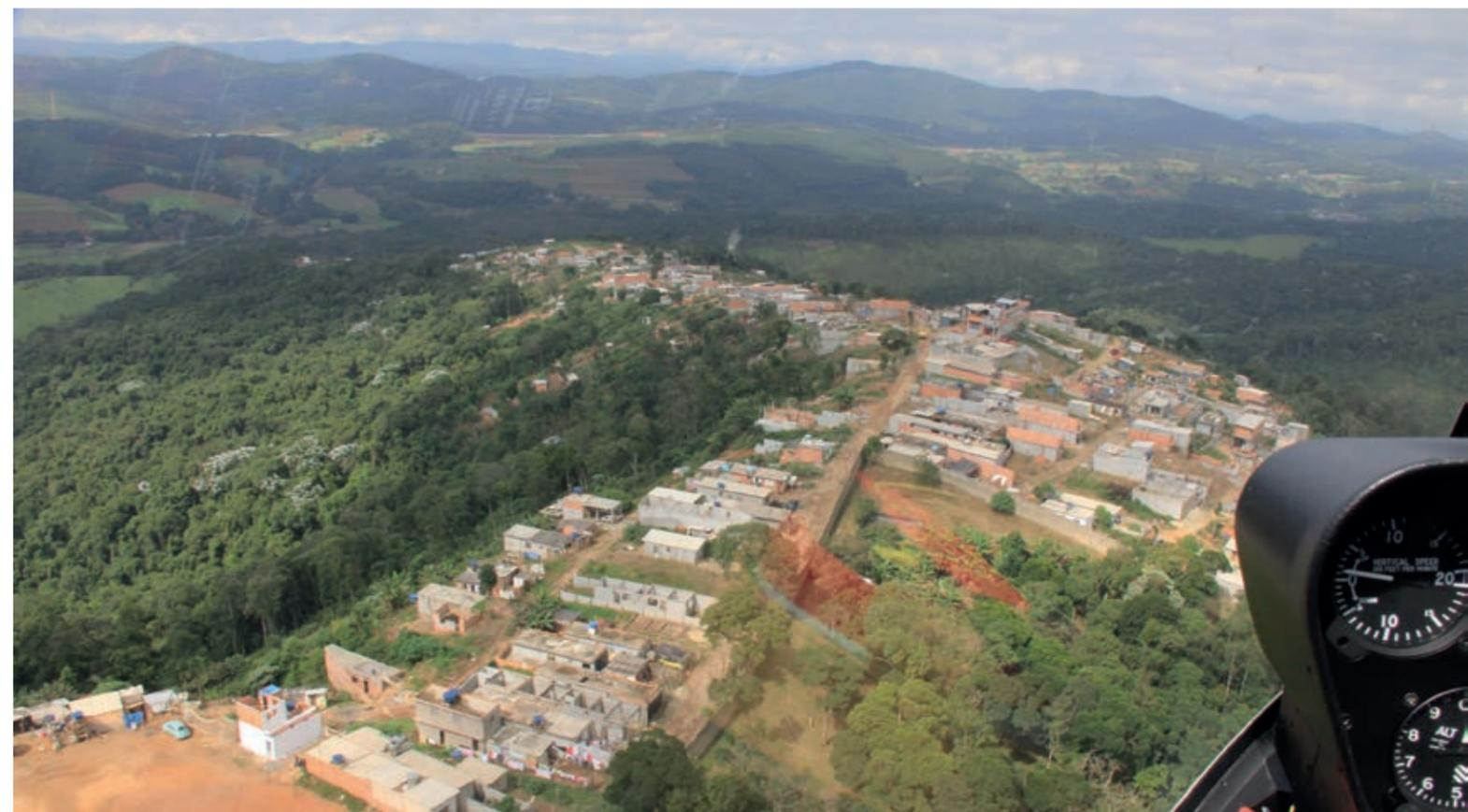
Figura 13 - Ferraz de Vasconcelos – Ocupações irregulares ao sul do Jardim Pérola III. Notar a ocupação do estreito espigão, que obriga a implantação arriscada das construções, beirando área de alta declividade. Fonte: foto do autor/PDFV 2015
