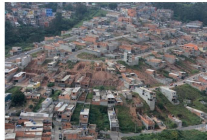
Figura 6 – Ferraz de Vasconcelos – Vila Jamil. Detalhe do modo de ocupação de terreno com declividade acentuada. As construções ignoram a condição topográfica original, transformando os lotes em planos horizontais por meio de cortes profundos. Originam-se, assim, taludes praticamente verticais, sem qualquer cuidado geotécnico ou de drenagem. Fonte: foto do autor/PDFV 2015.
