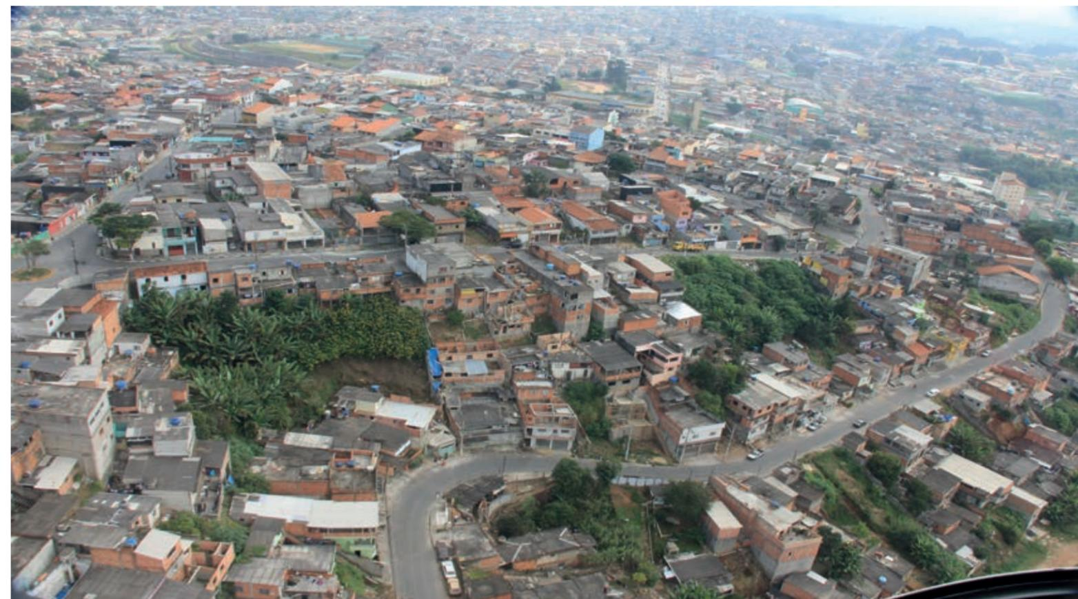
Figura 12 - Ferraz de Vasconcelos – Parque São Francisco. Evidencia-se o acentuado desnível entre as vias. Notar as duas áreas vegetadas, resultado de escorregamentos anteriores registrados no Relatório Técnico IPT nº 133022-205/2013. Classificada com área de risco de desabamento. O padrão de ocupação periférico, a urbanização incompleta. E os fragmentos residuais de solo, hiatos espaciais. Fonte: foto do autor/PDFV 2015
