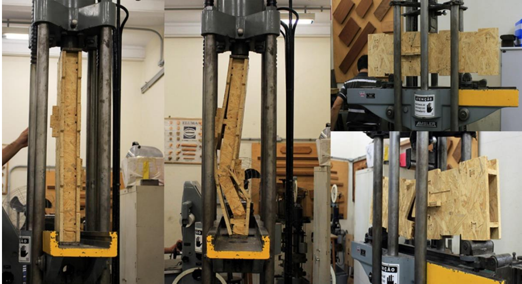
Figura 49 – Ensaio de flexão elástica e compressão axial.
