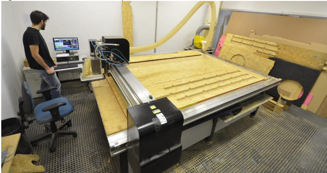
Figura 32 – Fresadora CNC adquirida com recursos da FINEP.
