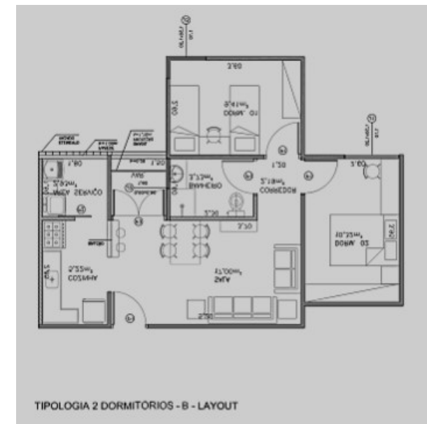
Fig. 140 – João Cândido, plantas tipo, têm número recomendado de leitos. Notar, na UH três dormitórios, a TV posicionada em ângulo desfavorável e a largura insuficiente para escrivaninha no quarto menor. Anotações da autora sobre desenho fornecido pela Usina-CTAH.
