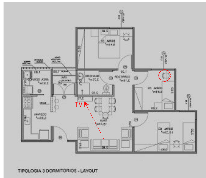
Fig. 140 – João Cândido, plantas tipo, têm número recomendado de leitos. Notar, na UH três dormitórios, a TV posicionada em ângulo desfavorável e a largura insuficiente para escrivaninha no quarto menor. Anotações da autora sobre desenho fornecido pela Usina-CTAH.
