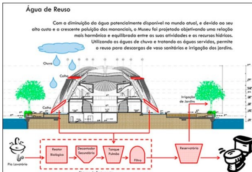
Figura 250. Esquema. Reuso de água do Museu do Amanhã. Disponível em: < https://www.portomaravilha.com.br/portomaravilha >. Acesso em: 26 abr. 2017.
