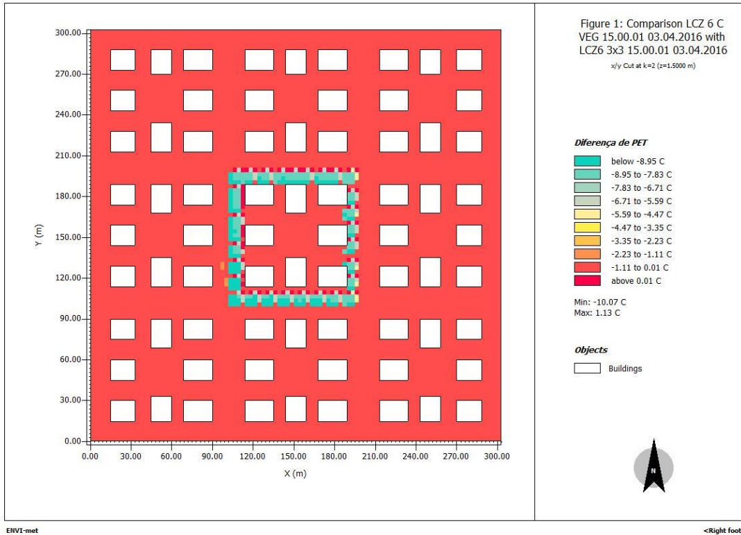
Figura 97: Diferença de PET entre o cenário LCZ 6 com vegetação e o cenário LCZ 6 (sem vegetação) - Cenário climático atual. Fonte: Autor.
