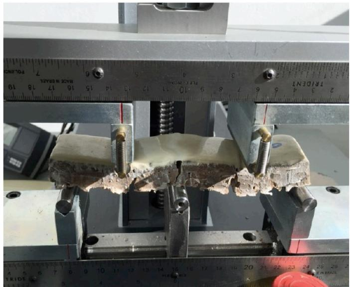
**(c)** Arranjo do ensaio de tração na flexão do prisma de concreto (dimensões 16x4x2 cm) com sistema de impermeabilização elastomérica aderida (VASCONCELOS, 2015, p.78)
