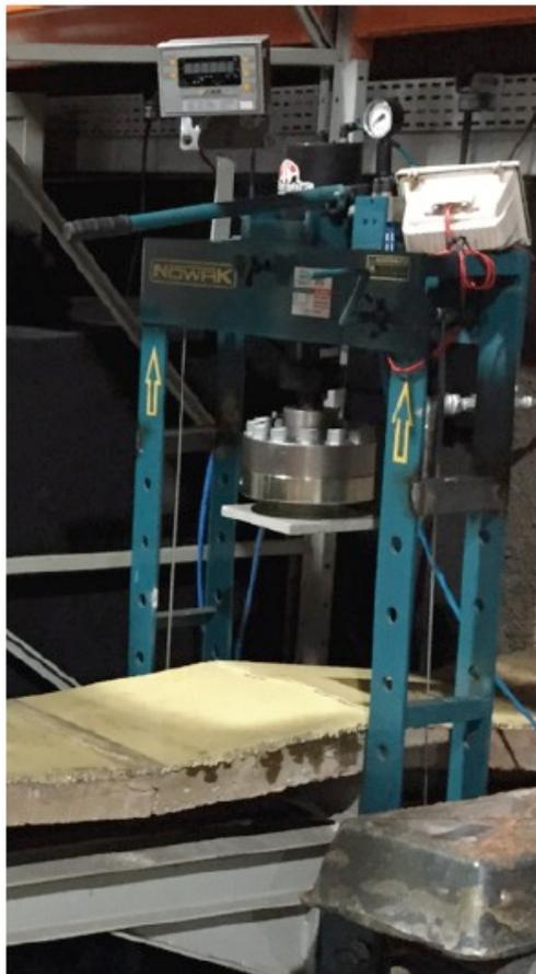
**(b)** Arranjo de ensaio de tração na flexão de laje de concreto armado (dimensões 200x45x7 cm) com sistema de impermeabilização elastomérica aderida (VASCONCELOS, 2015, p.77)
