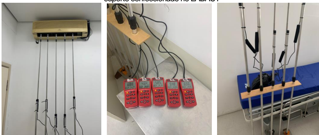
Figura 57 - Medição da temperatura, velocidade e umidade relativa do ar na saída do ar-condicionado, com suporte confeccionado no LABAUT
