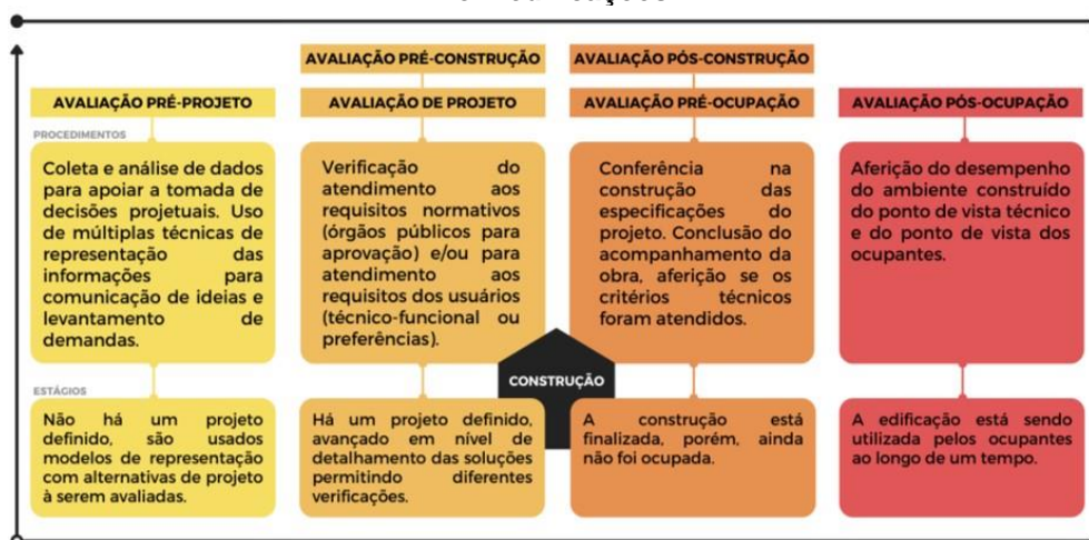
Figura 1: Modelo conceitual da caracterização do ciclo avaliativo do processo de projeto em edificações
