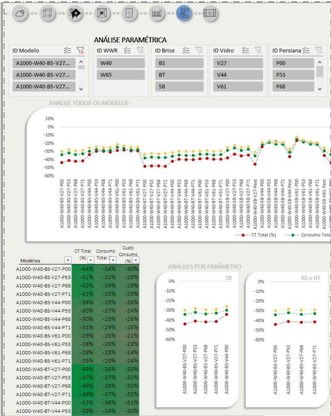
Figura 95 - Painel de Análise Complementar: Consumo de Energia – Edifício – Ampliação 2 de 3
