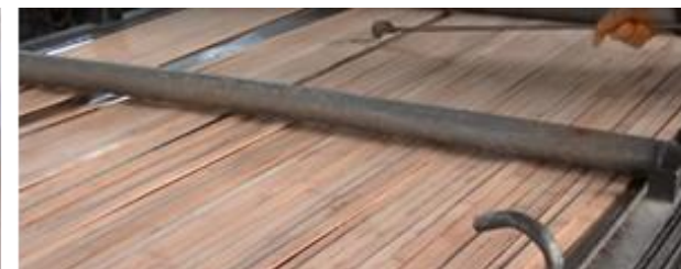
Figura 35: Processo de colagem das ripas. Fonte: Greenington bamboo furniture (2020) adaptado pela autora (2021)
