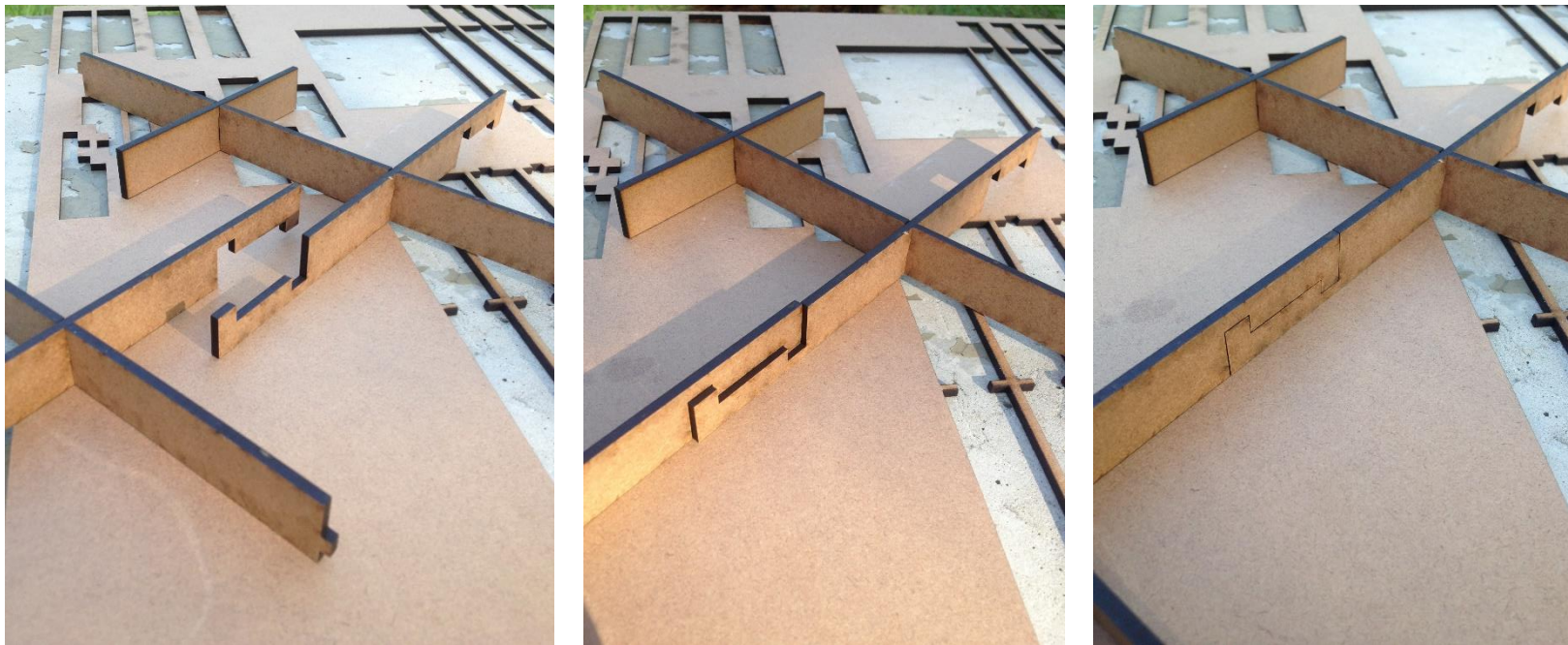
Figura 176: Modelo físico - escala reduzida – em MDF 3mm: corte CNC laser . Composição entre os encaixes longitudinal e ortogonal: opção 1 do encaixe perpendicular entre as peças; e opção 3 do encaixe de prolongamento das peças. Fonte: Autora (2017).
