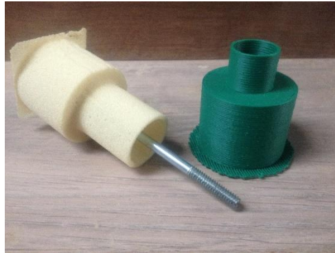
Figura 145: O mesmo objeto confeccionado na fresadora CNC [esquerda] e na impressora 3D [direita]. Fonte: Autora (2016).
