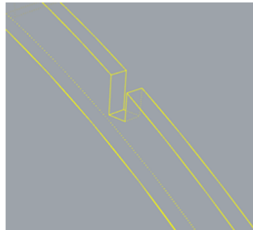
Figura 273: Encaixe de corte perpendicular. Peça inferior. Corte definido: 50%. Fonte: Autora (2018).
