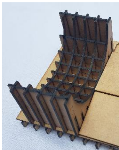
Figura 347: Montagem do modelo físico – em MDF - após corte na CNC laser. Fonte: Croffi e Ruggiero (2016).
