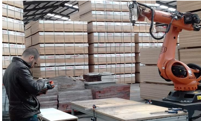
Figuras 299 e 300: Comandos por controle remoto para instruções de corte das peças pelo braço robótico KUKA. Fonte: Autora (2019).
