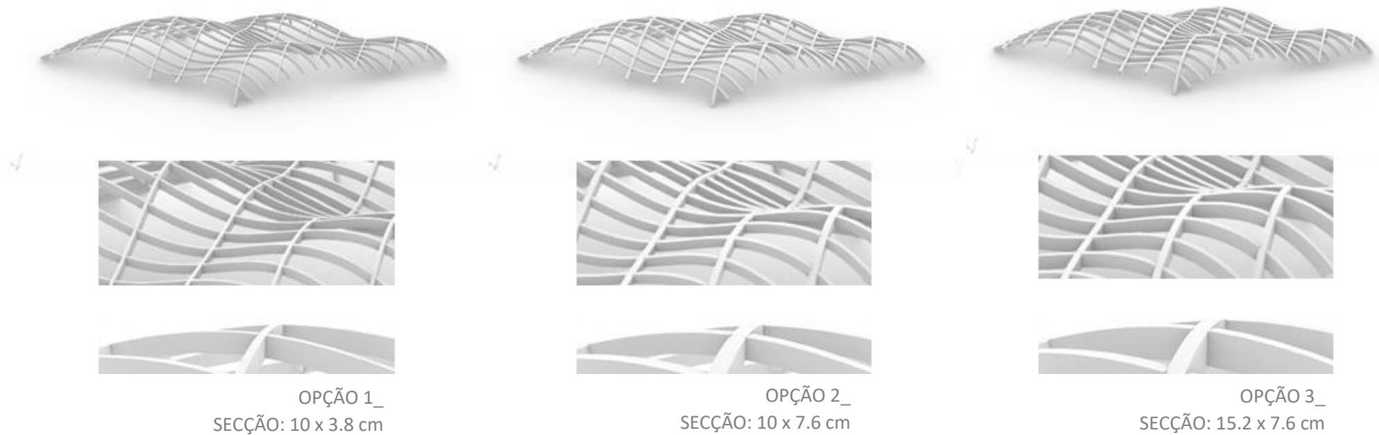
Figura 320: Configurações da estrutura reticulada considerando as três opções de secções. Fonte: Borçato e Ruggiero (2021).
