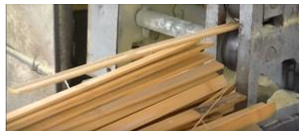
Figura 25: Aplainamento das ripas de bambu. Fonte: Greenington bamboo furniture (2020) adaptado pela autora (2021).
