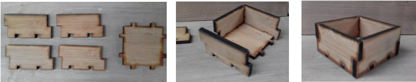
Figura 190: Caixa de bambu laminado: modelo 2. Corte na CNC laser Fonte: Autora (2018).
