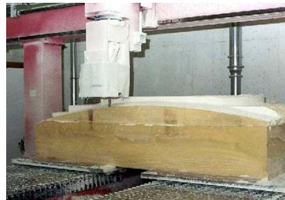
Figura 152: Confeção de moldes: técnica de subtração. Fonte: Henriques (2005) adaptado pela autora (2020).
