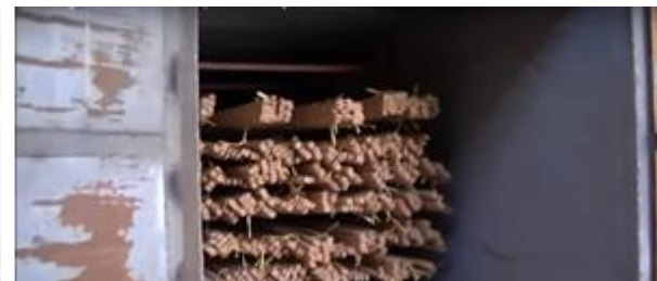
Figura 29: Ripas acondicionadas no forno - para secagem - após tratamento térmico. Fonte: Greenington bamboo furniture (2020) adaptado pela autora (2021).
