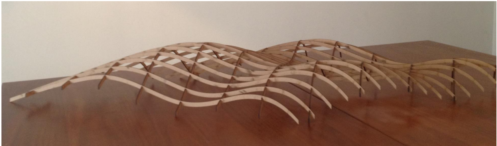
Figura 266: Modelo físico – escala reduzida – da estrutura reticulada. Peças cortadas na CNC laser . Montagem, apenas, por meio dos encaixes. Fonte: Autora (2016).
