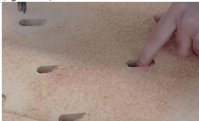
Figuras 302 e 303: Início dos cortes das peças - nas placas de bambu laminado - pelo braço robótico KUKA. Fonte: Autora (2019).
