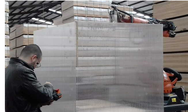
Figura 301: Proteção para execução dos cortes das peças pelo braço robótico KUKA. Fonte: Autora (2019).
