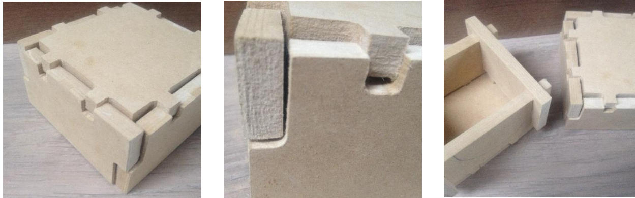
Figuras 218 a 220: Caixinha [modelo 2] executada na CNC fresadora. Fonte: Autora (2018).
