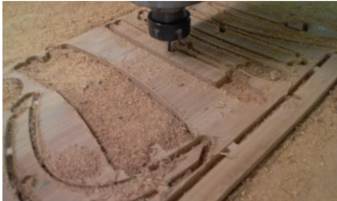
Figura 286: Placa de bambu laminado durante processo na CNC fresadora. Fonte: Autora (2018).
