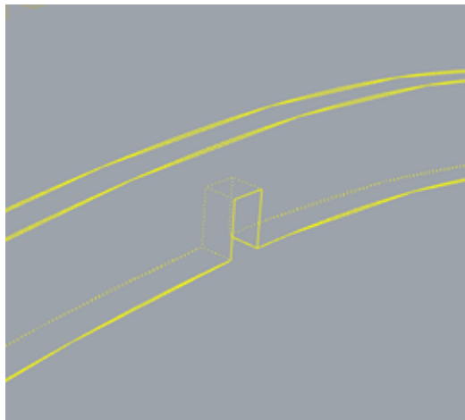
Figura 272: Encaixe de corte perpendicular. Peça superior. Corte definido: 50%. Fonte: Autora (2018).
