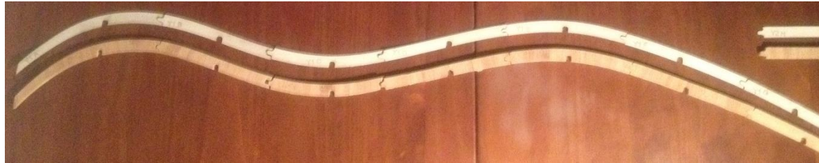
Figura 289: Peças de bambu laminado com encaixes longitudinais. Fonte: Autora (2018).
