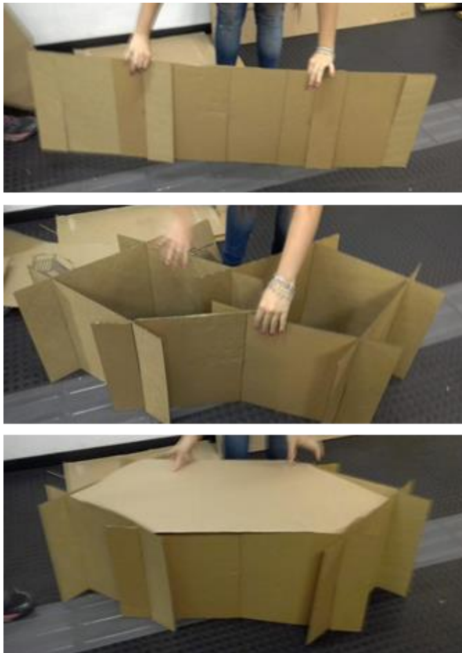
Figura 365: Montagem das peças - de papelão – cortadas na CNC laser . Fonte: Autora (2018).
