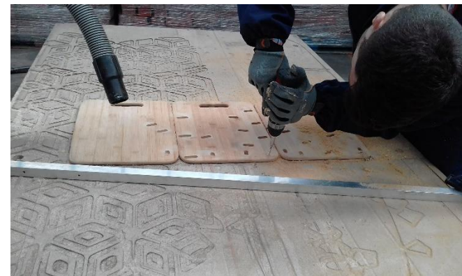
Figura 304: Repetição da etapa de fixação das placas de bambu laminado, na mesa de corte do braço robótico KUKA, após a realização dos primeiros cortes. Fonte: Autora (2019).
