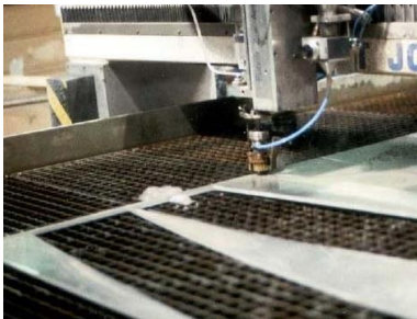
Figura 151: Corte das chapas metálicas. Fonte: Henriques (2005) adaptado pela autora (2020).
