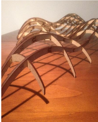
Figuras 281 a 283: Modelo físico – escala reduzida – da estrutura reticulada. Corte das peças na CNC laser . Desenhos dos encaixes de prolongamento – rabo de andorinha - adaptados para futura execução na CNC fresadora. Fonte: Autora (2018).
