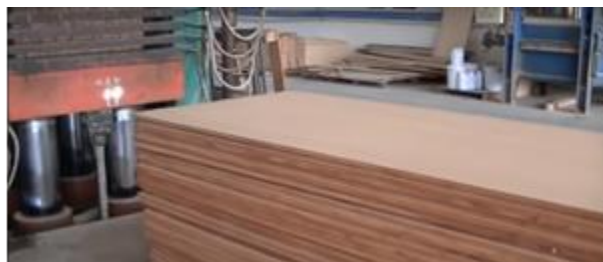
Figura 40: Placas de bambu laminado finalizadas. Fonte: Greenington bamboo furniture (2020) adaptado pela autora (2021)
