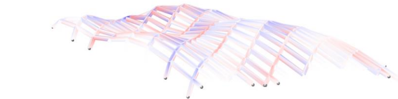
Figura 326: Esforços de tração e compressão na estrutura reticulada opção 3. Fonte: Borçato e Ruggiero (2021).
