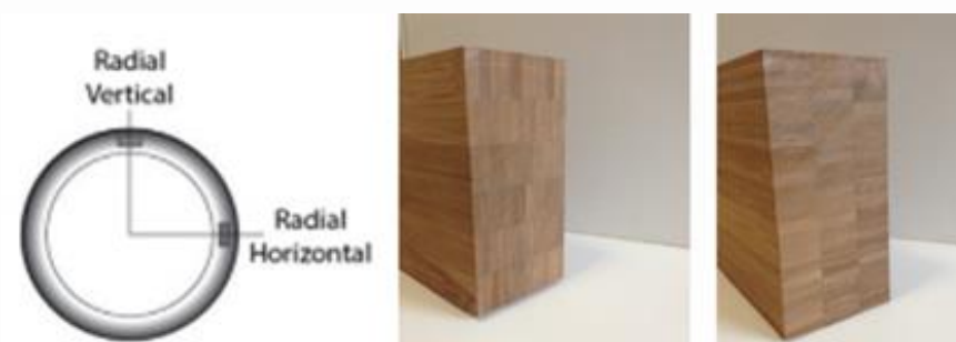
Figura 48: Peças de bambu laminado: orientação das fibras radial horizontal e radial vertical. Fonte: SHARMA et al. (2015) - adaptado pela autora (2021).
