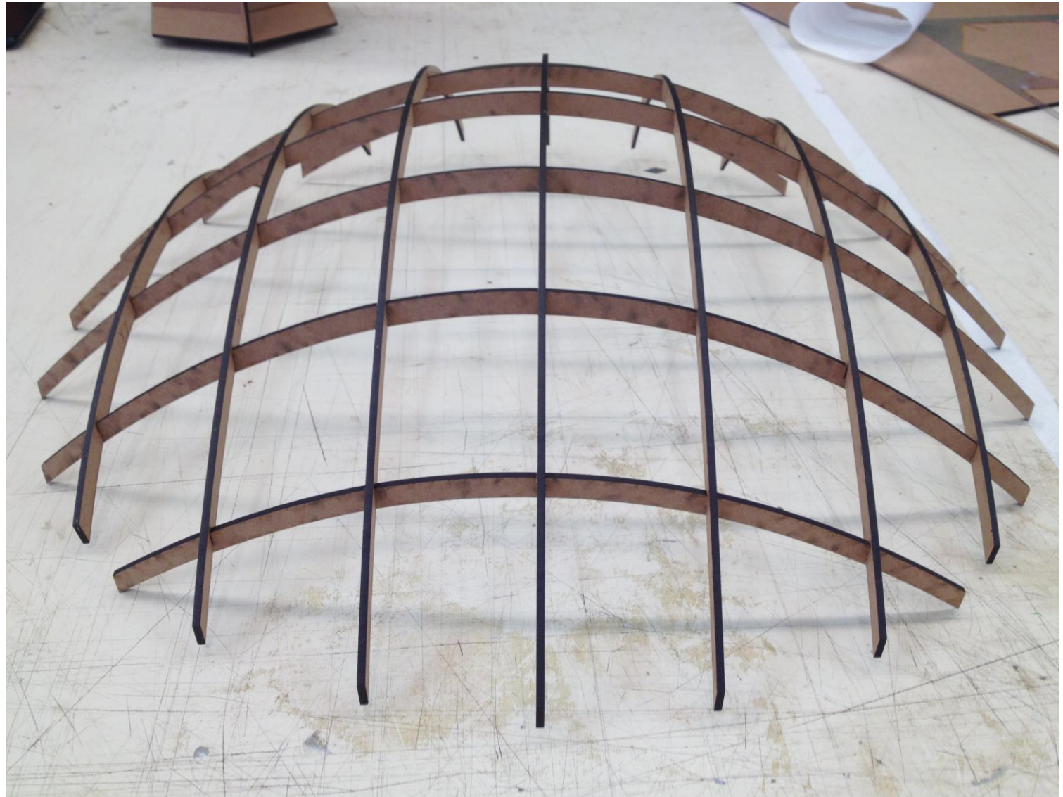
Figura 170: Modelo físico - escala reduzida – em MDF 3mm. Corte à laser a partir dos desenhos das peças planificadas oriundas da definição do Grasshopper . Fonte: Autora (2016).
