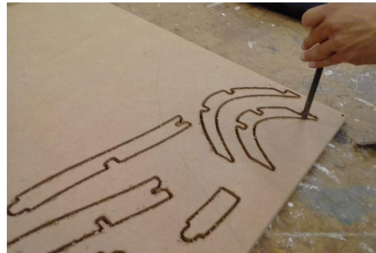
Figura 285: Retirada manual das peças – da placa de aglomerado – após execução na CNC fresadora. Fonte: Autora (2018).
