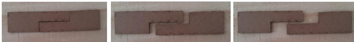
Figura 172: Modelo físico - escala reduzida – em MDF 3mm: corte CNC laser . Encaixe de prolongamento das peças: opção 2. Fonte: Autora (2017).
