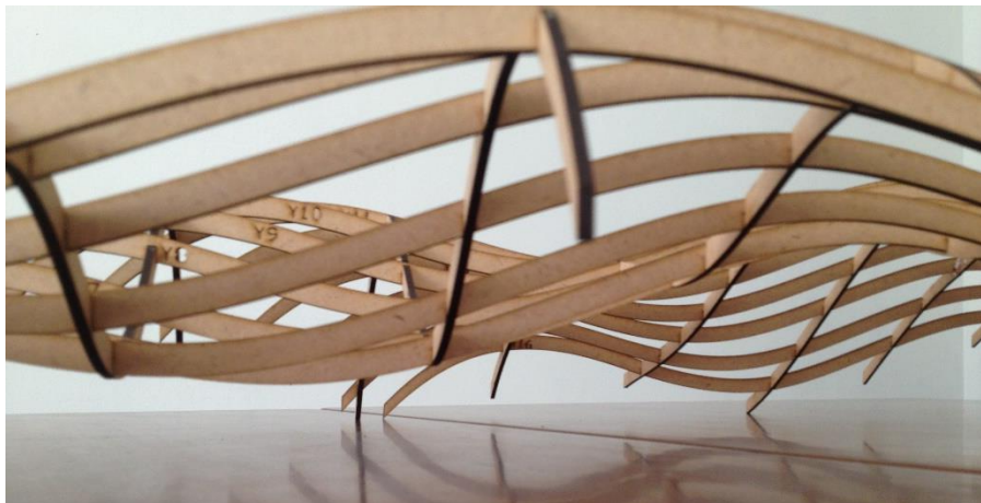
Figura 267: Detalhe do modelo físico – escala reduzida – da estrutura reticulada. Peças à esquerda apresentam as gravações realizadas pela CNC laser . Fonte: Autora (2016).
