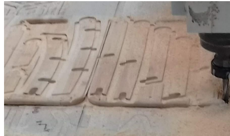
Figuras 305 a 308: Execução dos cortes das peças - nas placas de bambu laminado - pelo braço robótico KUKA. Fonte: Autora (2019).
