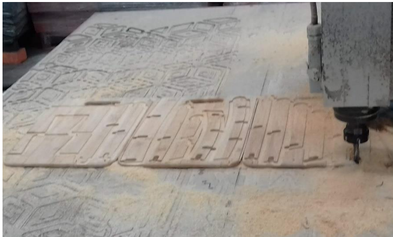
Figuras 305 a 308: Execução dos cortes das peças - nas placas de bambu laminado - pelo braço robótico KUKA. Fonte: Autora (2019).
