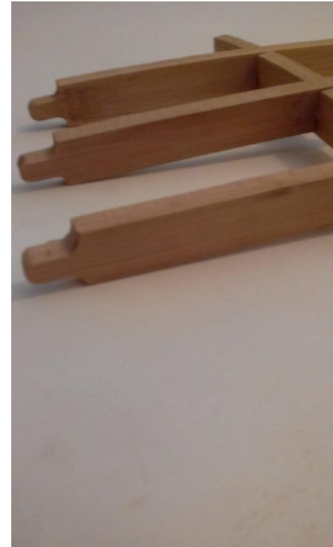
Figura 313: Peças de bambu laminado: encaixe longitudinal. Fonte: Autora (2019).
