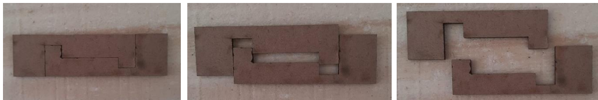
Figura 173: Modelo físico - escala reduzida – em MDF 3mm: corte CNC laser . Encaixe de prolongamento das peças: opção 3. Fonte: Autora (2017).
