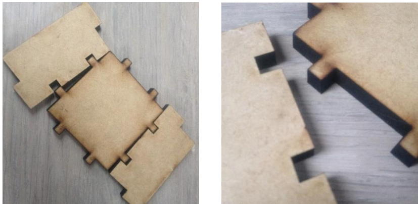
Figuras 221 e 222: Caixinha [modelo 2] cortada na CNC laser . Fonte: Autora (2018).
