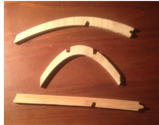
Figura 291: Peças de bambu laminado: executadas na CNC fresadora. Fonte: Autora (2018).
