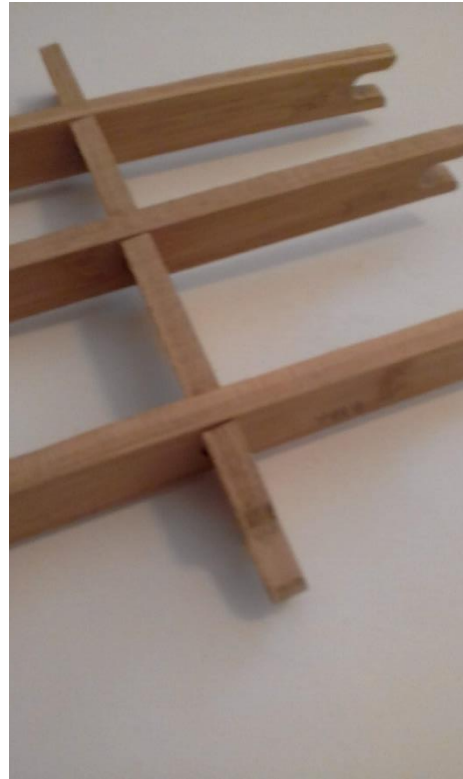
Figura 312: Peças de bambu laminado: encaixe perpendicular. Fonte: Autora (2019).
