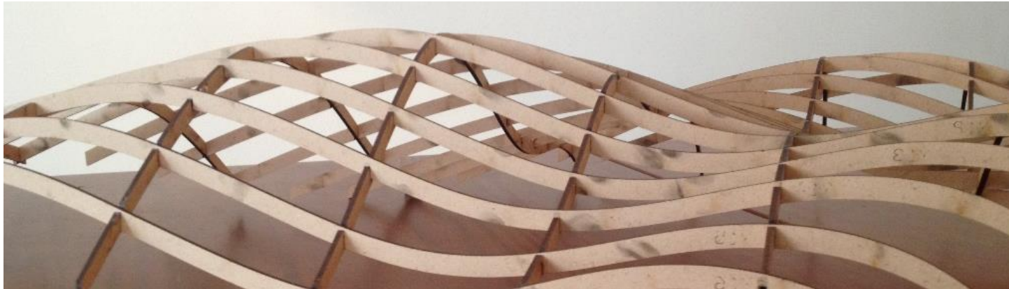
Figura 269: Modelo físico – escala reduzida – da estrutura reticulada. Bordas das peças carbonizadas, em decorrência do processo de corte na CNC laser . Fonte: Autora (2016).
