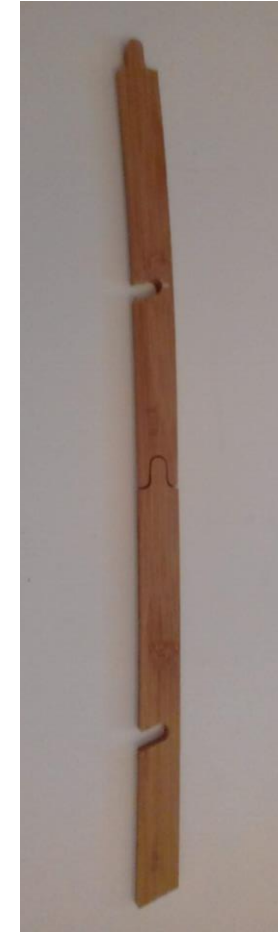
Figura 310: Peças de bambu laminado – encaixe longitudinal – executadas no braço robótico KUKA, do DFL. Fonte: Autora (2019).
