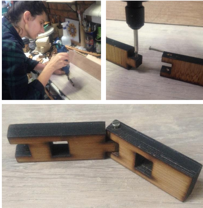
Figuras 193 a 195: Perfuração e fixação dos parafusos nas peças com encaixes longitudinais articulados. Fonte: Autora (2018).
