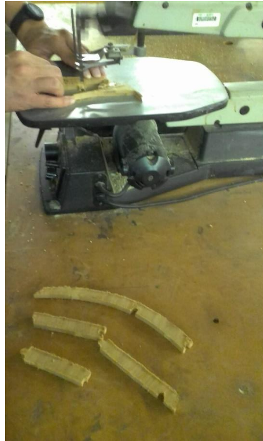
Figura 288: Acabamento das peças de bambu laminado, utilizando serra de fita, após processo na CNC fresadora. Fonte: Autora (2018).
