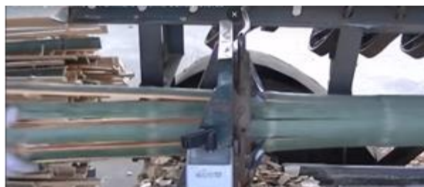
Figura 22: Vista lateral do corte longitudinal dos colmos. Fonte: Greenington bamboo furniture (2020) adaptado pela autora (2021).
