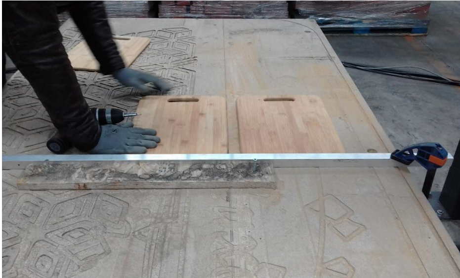
Figura 297: Fixação das placas de laminado de bambu na mesa de corte do braço robótico KUKA do laboratório DFL. Fonte: Autora (2019).
