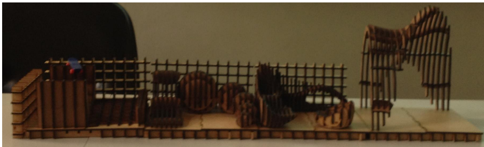
Figura 349: Protótipos – escala reduzida – em MDF. Peças cortadas na CNC laser . Composição com os 4 módulos distintos. Fonte: Croffi e Ruggiero (2016).
