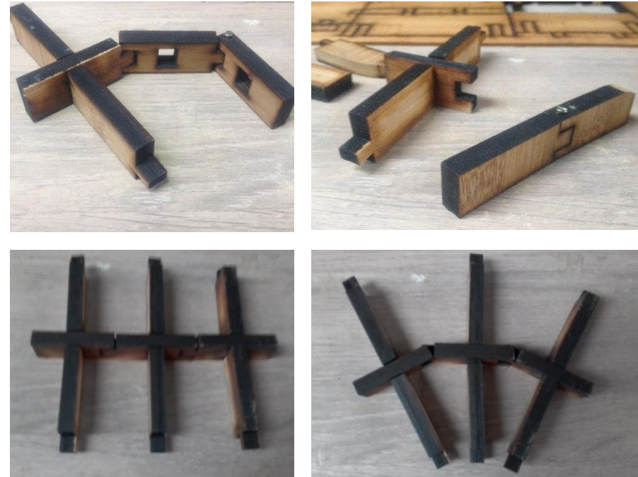
Figuras 196 a 199: Composições de peças com encaixes longitudinais articulados; e encaixes ortogonais entre 3 peças. Fonte: Autora (2018).
