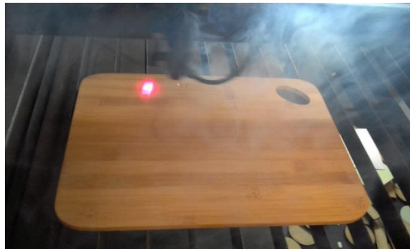
Figura 177: Placa de bambu laminado 8mm: corte CNC laser . Processo de gravação das peças. Fonte: Autora (2018).
