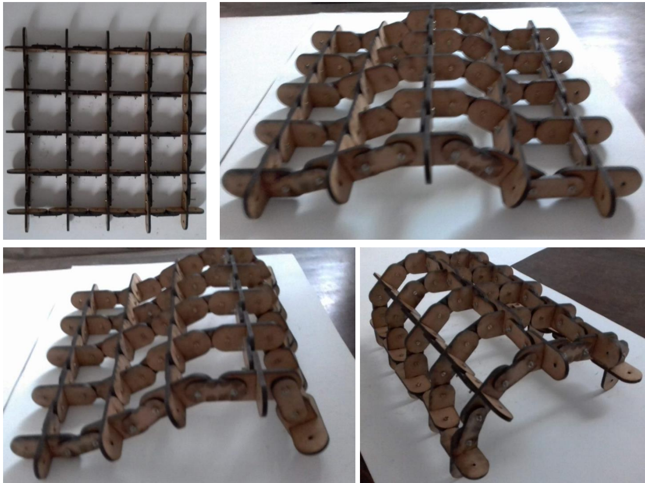
Figuras 214 a 217: Possibilidades de configurações – da malha articulada – com peças idênticas. Fonte: Autora (2018).
