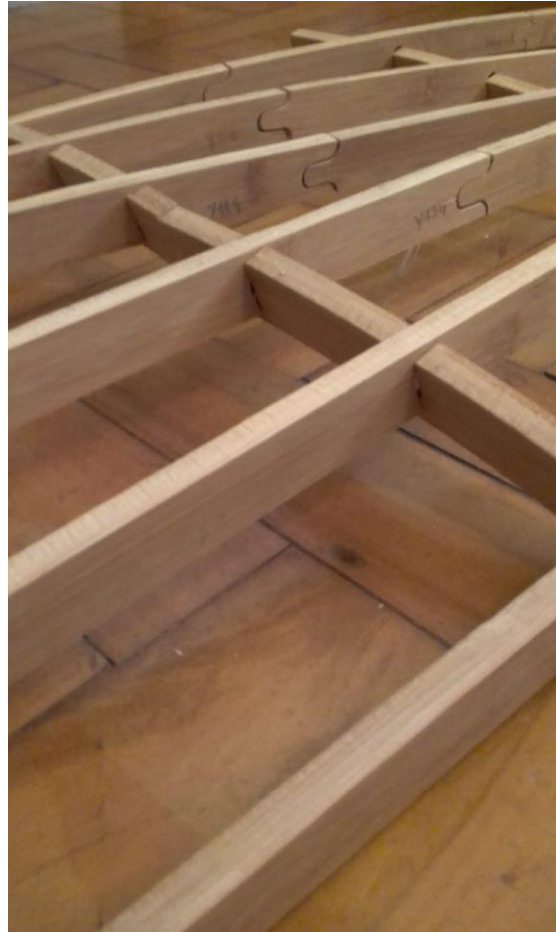
Figura 309: Peças de bambu laminado – trecho da estrutura reticulada em estudo – escala reduzida. Fonte: Autora (2019).
