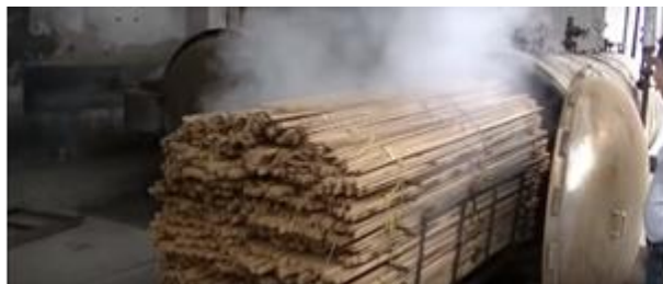
Figura 28: Retirada das ripas, do vaporizador, após tratamento térmico. Fonte: Greenington bamboo furniture (2020) adaptado pela autora (2021).
