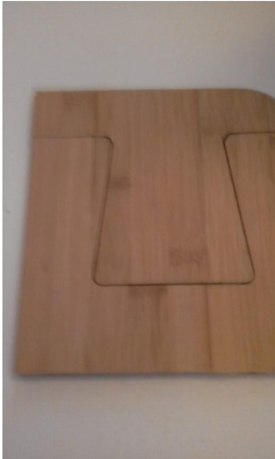
Figuras 314 e 315: Peças de bambu laminado: encaixe longitudinal tipo rabo de andorinha Fonte: Autora (2019).
