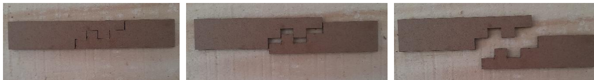
Figura 174: Modelo físico - escala reduzida – em MDF 3mm: corte CNC laser . Encaixe de prolongamento das peças: opção 4. Fonte: Autora (2017).
