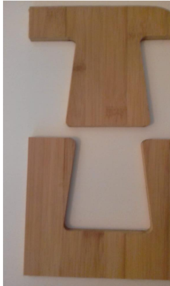
Figuras 314 e 315: Peças de bambu laminado: encaixe longitudinal tipo rabo de andorinha Fonte: Autora (2019).
