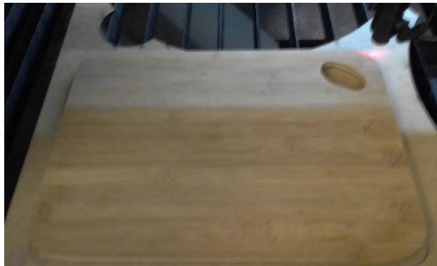
Figura 187: Início do corte: segundo teste. Placa de bambu laminado sobre chapa de MDF. Fonte: Autora (2018).
