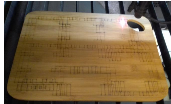
Figura 178: Placa de bambu laminado 8mm: corte CNC laser . Processo de gravação das peças. Fonte: Autora (2018).
