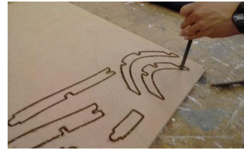
Figura 224: Peças executadas na CNC fresadora: aglomerado de madeira. Fonte: Autora (2018).
