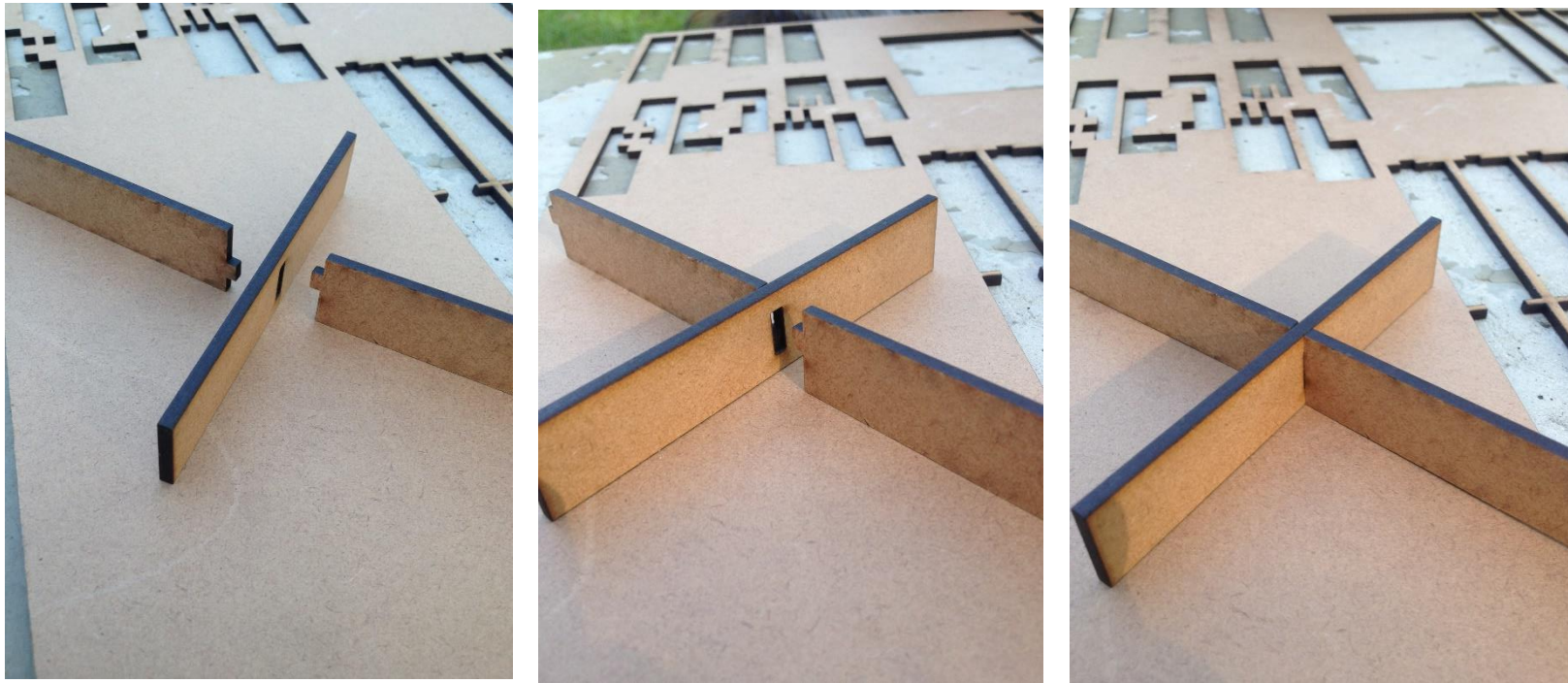
Figura 175: Modelo físico - escala reduzida – em MDF 3mm: corte CNC laser . Encaixe perpendicular entre as peças: opção 1. Fonte: Autora (2017).
