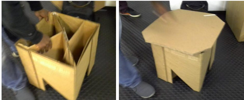
Figura 364: Montagem das peças - de papelão – cortadas na CNC laser . Fonte: Autora (2018).
