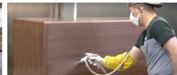
Figura 44: Aplicação de stain nos móveis de bambu laminado. Fonte: Greenington bamboo furniture (2020) adaptado pela autora (2021)
