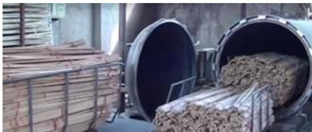
Figura 27: Feixes de ripas sendo colocados no vaporizador, para tratamento térmico. Fonte: Greenington bamboo furniture (2020) adaptado pela autora (2021).
