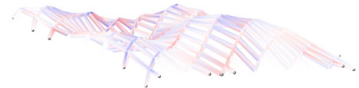
Figura 327: Esforços de tração e compressão na estrutura reticulada opção 3: simulação com deformação de 60%. Fonte: Borçato e Ruggiero (2021).
