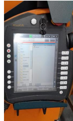
Figuras 299 e 300: Comandos por controle remoto para instruções de corte das peças pelo braço robótico KUKA. Fonte: Autora (2019).
