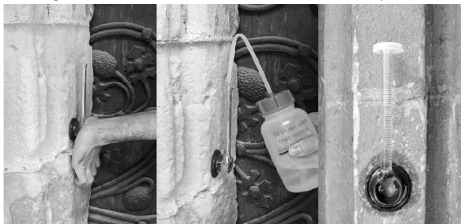
Figura 149 - Preenchimento do tubo de Karsten com pisseta.
