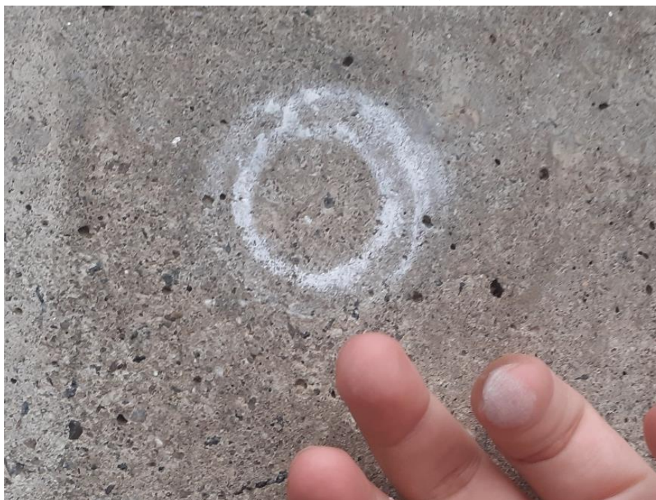
Figura 156 - Marca da massa de calafetar dias após o ensaio com tubo de Karsten, imagem ilustra a facilidade de remoção.
