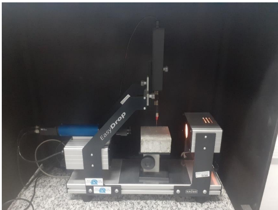
Figura 166 -Goniômetro contendo o corpo de prova onde é depositada a gota de água a partir da qual é feita a medição do ângulo de contato.
