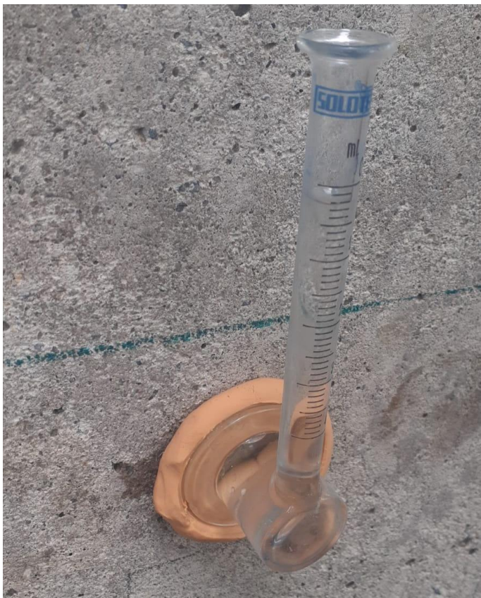
Figura 139 - Fixação do tubo de Karsten com plastilina, com má aderência e vazamento.
