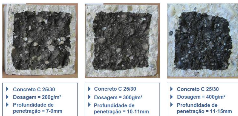
Figura 91 - Diferentes profundidades de penetração para diferentes dosagens de creme hidrofugante com 80% de teor de sólidos.
