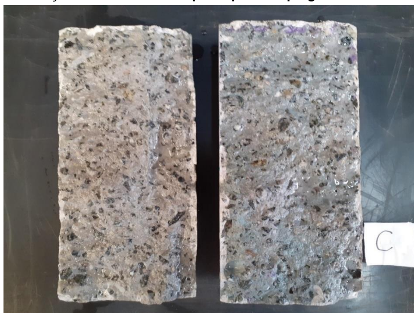
Figura 194 - 1ª seção transversal de corpo de prova impregnado com hidrofugante C.
