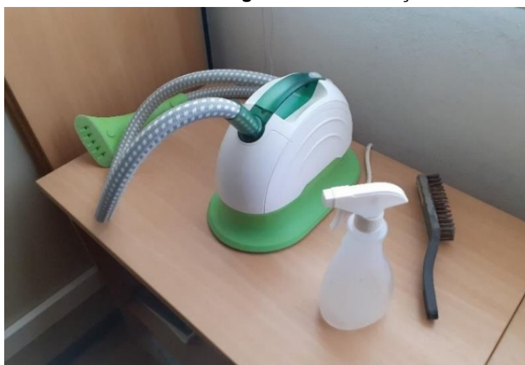
Figura 117 - Instrumentos utilizados para a limpeza da área de ensaio do pilar: vaporizador, borrifador de água e escova de aço.
