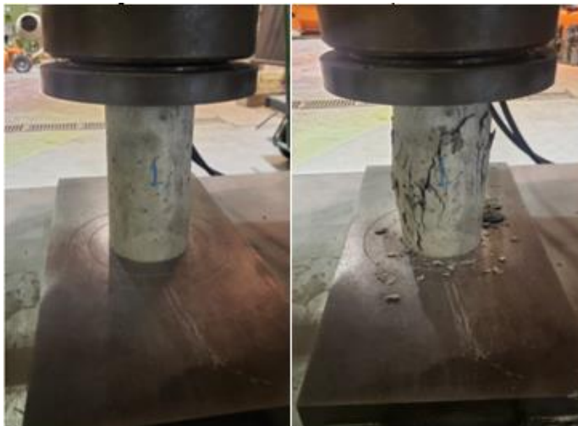
Figura 157 - Ensaio de resistência à compressão axial.
