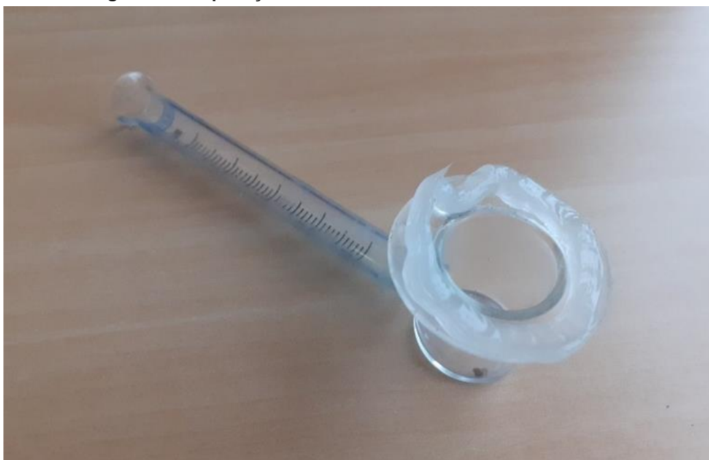
Figura 141 - Aplicação de silicone acético no tubo de Karsten.
