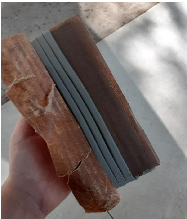
Figura 142 - A massa de calafetar normalmente é vendida em tiras da largura da borda do tubo de Karsten.
