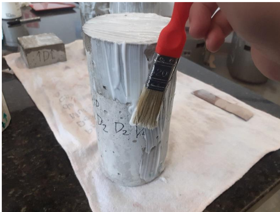
Figura 128 - Aplicação do creme hidrofugante em corpo de prova.
