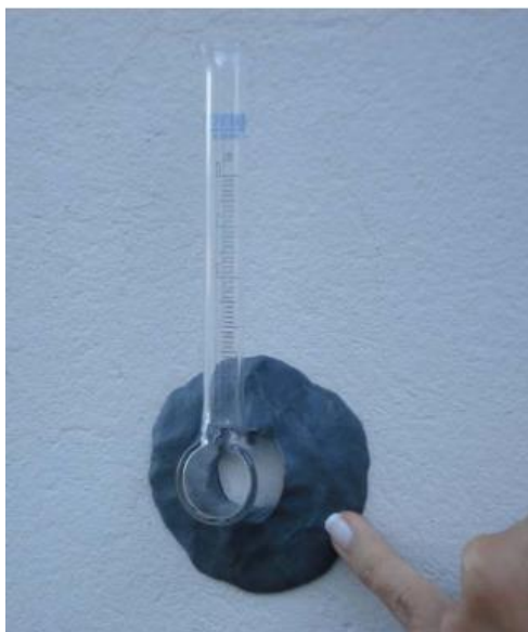
Figura 147 - Aplicação da massa de fixação no entorno do tubo de Karsten.
