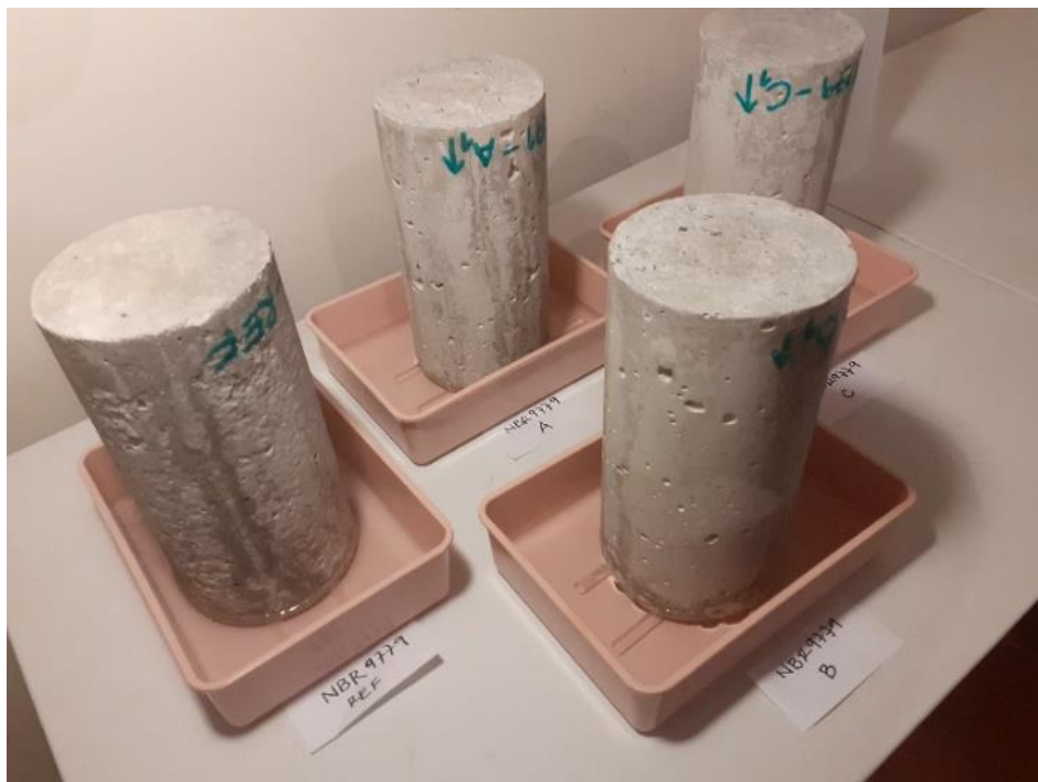
Figura 161 - Corpos de prova em recipientes preenchidos com água até a marca de 5mm.
