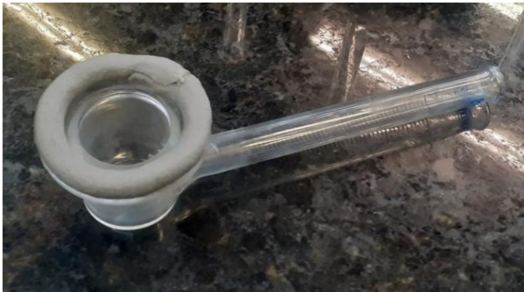
Figura 145 - Distribuição da massa de calafetar na borda do tubo de Karsten.
