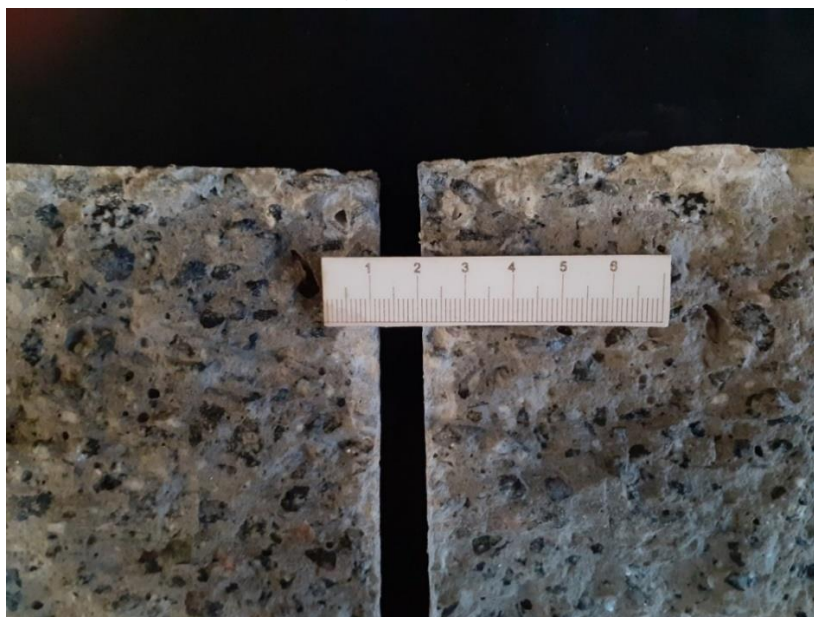
Figura 201 - Detalhe da borda do corpo de prova impregnado com hidrofugante D. A profundidade de penetração máxima observada foi de 12mm.
