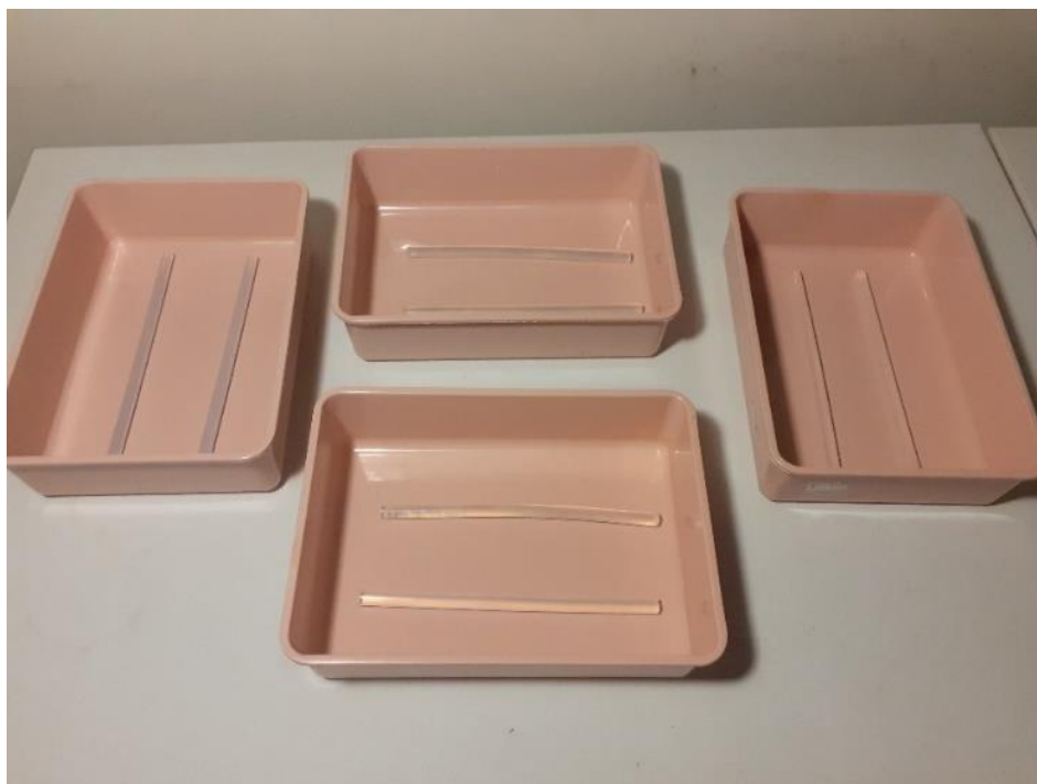
Figura 160 - Recipiente com bastões de silicone para apoiar a superfície de absorção dos corpos de prova.
