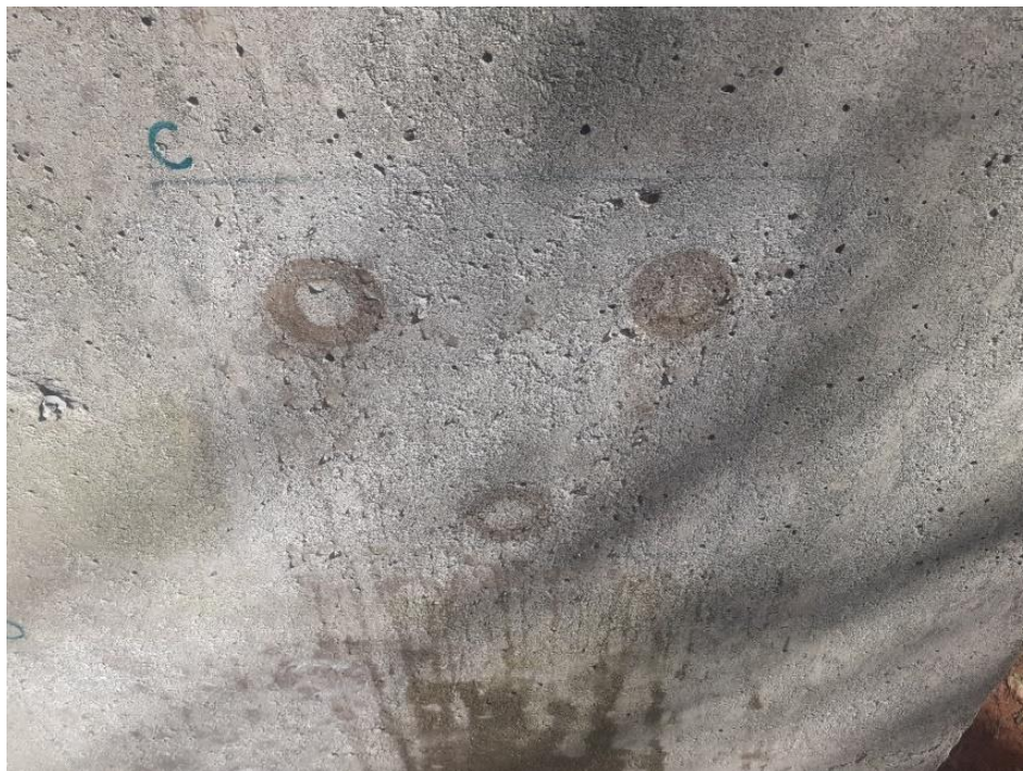
Figura 178 - Na área do hidrofugante C embora houvesse pouco molhamento, foi pouco perceptível a formação de gotículas superficiais, como nos hidrofugantes A e B.
