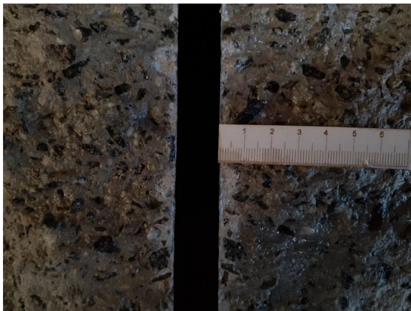
Figura 202 - Detalhe da borda do corpo de prova impregnado com hidrofugante D. A profundidade de penetração máxima observada foi de 12mm.
