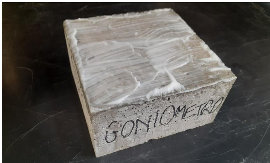
Figura 129 - Aplicação do creme hidrofugante.
