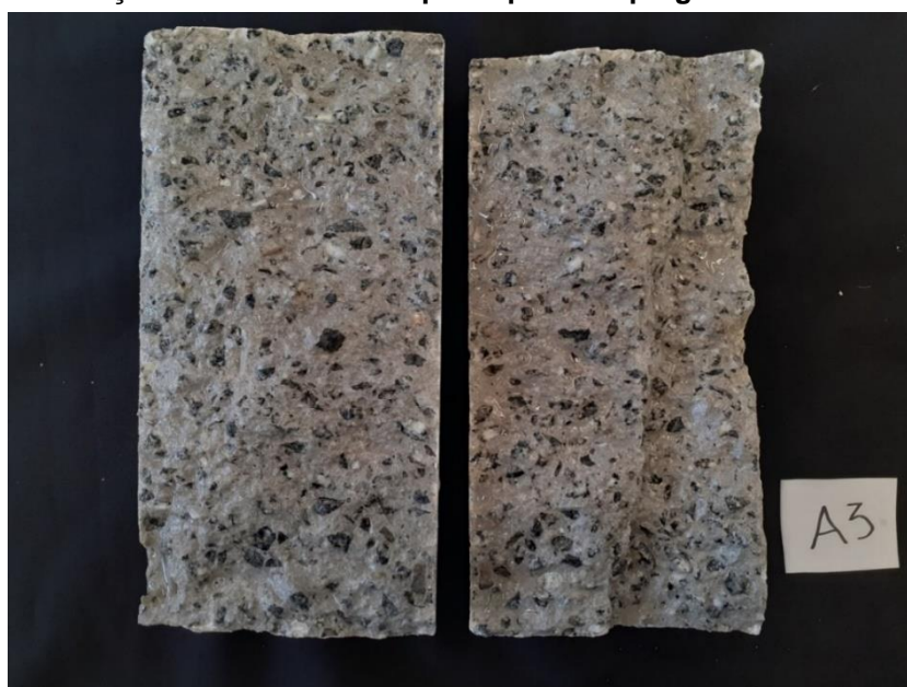
Figura 188 - 3ª seção transversal de corpo de prova impregnado com hidrofugante A.
