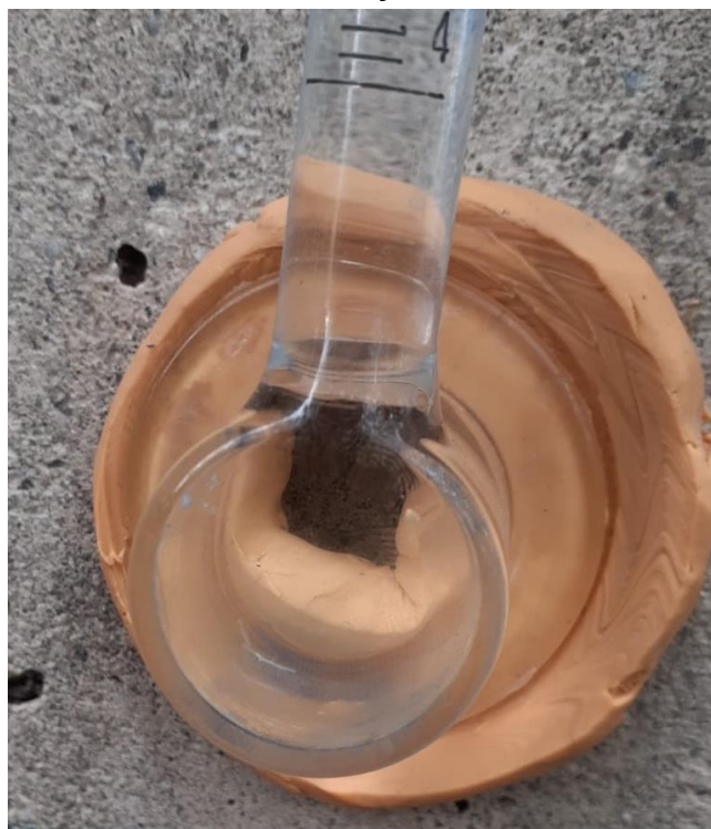
Figura 140 - Aplicação da plastilina em excesso para a fixação do tubo alterou a área de absorção.
