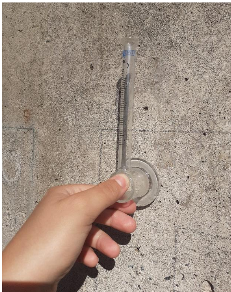
Figura 146 - Tubo de Karsten pressionado sobre a superfície para a fixação, mantendo-se o cuidado para não o quebrar.
