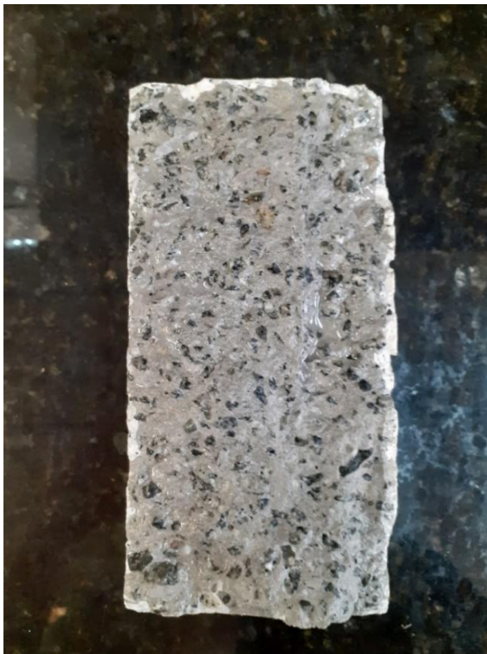
Figura 164 - Seção do corpo de prova após ser molhada com água. A área escura representa a que absorveu água e área mais clara (nas bordas) representa a penetração do hidrofugante, onde não houve absorção.
