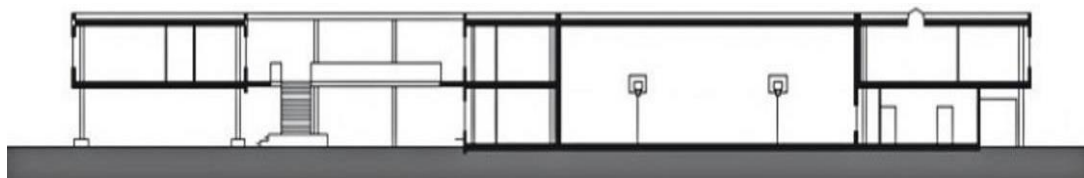
Figura 18: BM – Holanda - Corte passando pela quadra coberta
