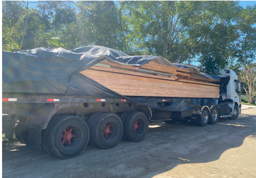
Figura 64: Veículo de transporte com segunda carga, incluindo painéis de MLCC e vigas de MLC.
