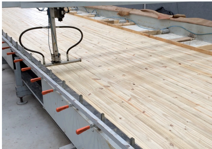
Figura 33: Etapa de prensagem dos painéis de MLCC, durante aplicação automática do adesivo estrutural acima de camada de lamelas dispostas na longitudinal.
