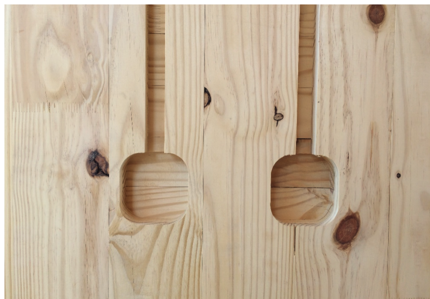
Figura 50: Usinagem para caixinha elétrica com cantos arredondados.
