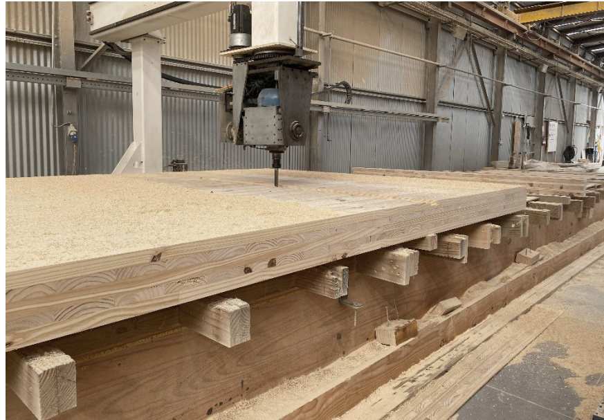
Figura 34: Usinagem de um painel de MLCC por meio da fresadora CNC com 5 eixos.
