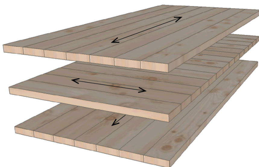
Figura 3: Esquema de confecção de painel de CLT ( Cross-Laminated Timber ).
