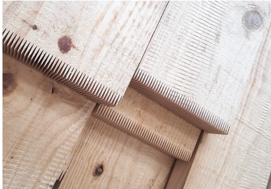
Figura 32: Lamelas de madeira após execução do corte para as emendas dentadas.
