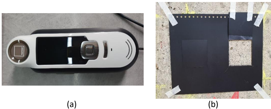
Figura 58: Imagens de (a) colorímetro tristímulo Capsure RM200 da X-Rite e (b) máscara em superfície preta com abertura de 8 x 8 cm para realização das leituras na superfície.
