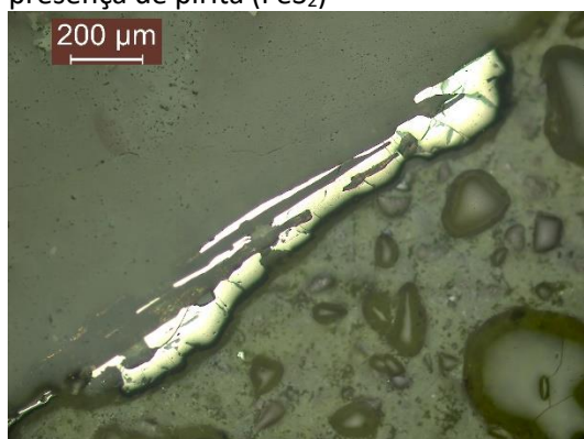
Figura 23: Imagem microscópica do concreto das empenas Noroeste e Nordeste, indicando presença de pirita ( \text{FeS}_2 )
