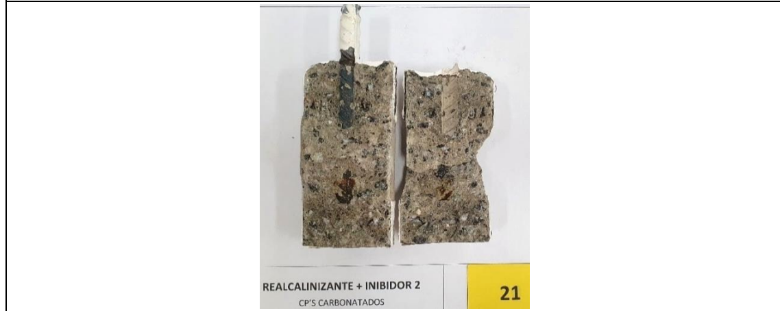
35% de área corroída, acúmulo significativo de productos
