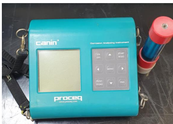
Figura 57: Equipamento utilizado na medição de potencial de corrosão no pilar 3 e o eletrodo de cobre com solução de sulfato de cobre.
