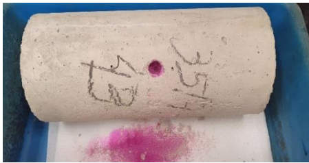
(a) Furo no CP para medida da profundidade de carbonatação
