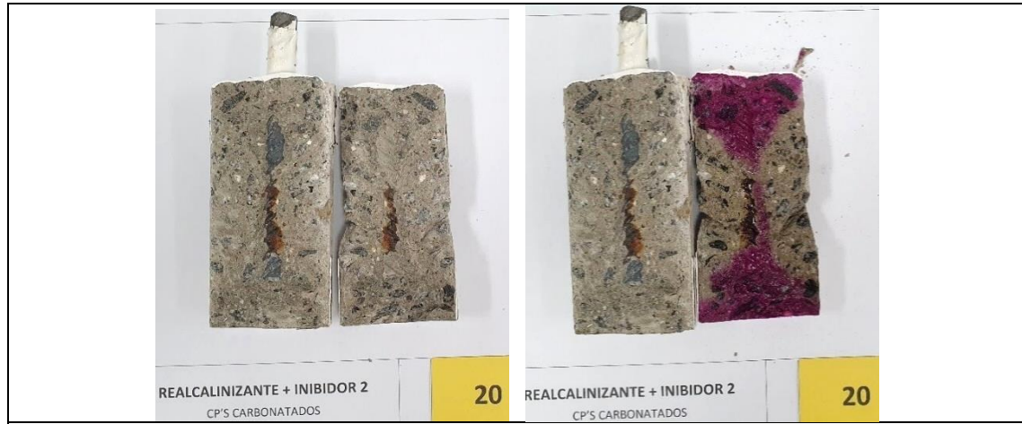
35% de área corroída, acúmulo significativo de productos, carbonatado parcialmente
