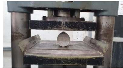
(b) Rompimento do CP por compressão diametral
