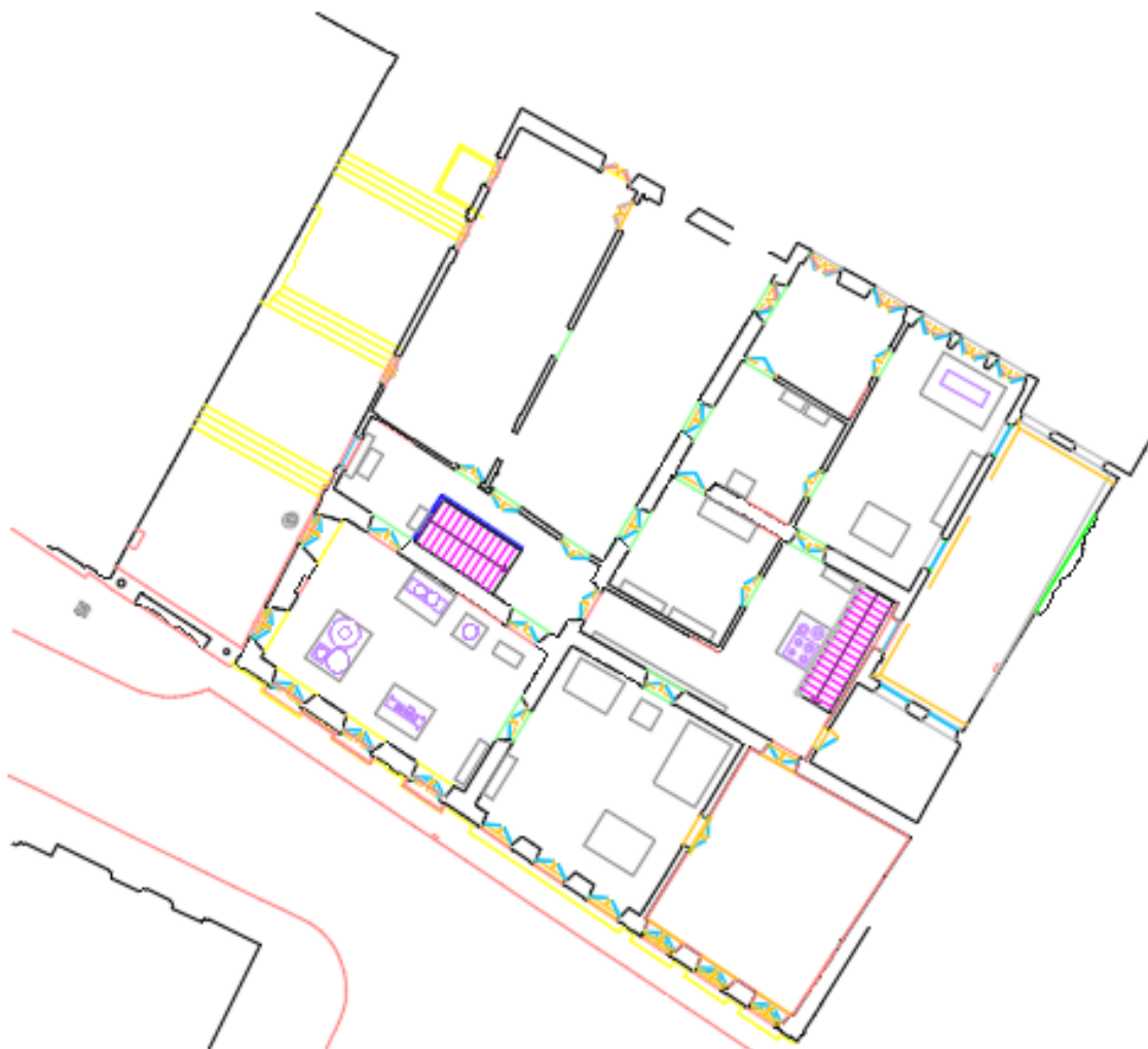
Figura 4.23 – Planta do superior do Solar, desenhada a partir da nuvem de pontos com software CAD.
