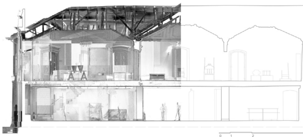
Figura 4.16 – Desenho com software CAD sobre a nuvem de pontos do Solar da Marquesa de Santos - corte.
