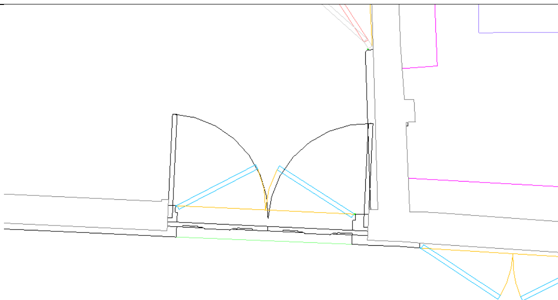
Figura 5.23 – Sobreposição do desenho da porta em CAD com o desenho gerado no software de modelagem BIM.
