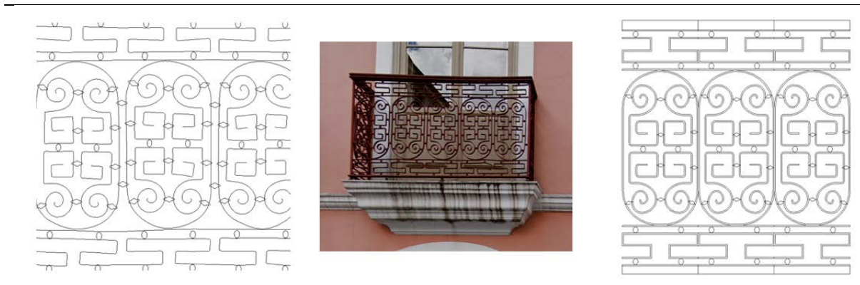
Figura 5.13 - (a) desenho CAD 2D, (b) fotografia, e (c) Modelo HBIM, de um parapeito de sacada.
