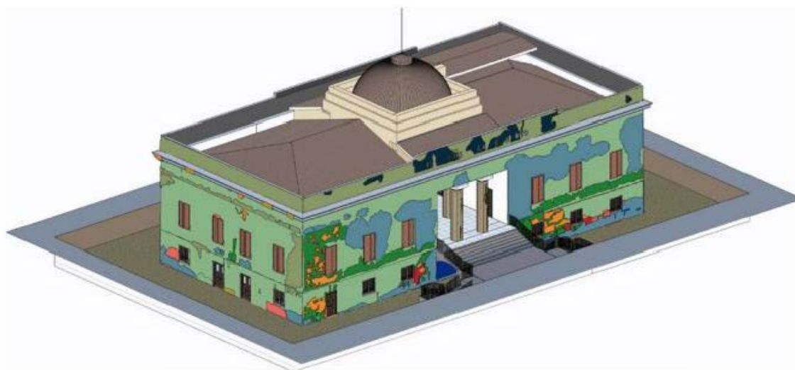
Figura 3.1 – Mapeamento das patologias e danos no modelo HBIM, Villa Castelnuovo.
