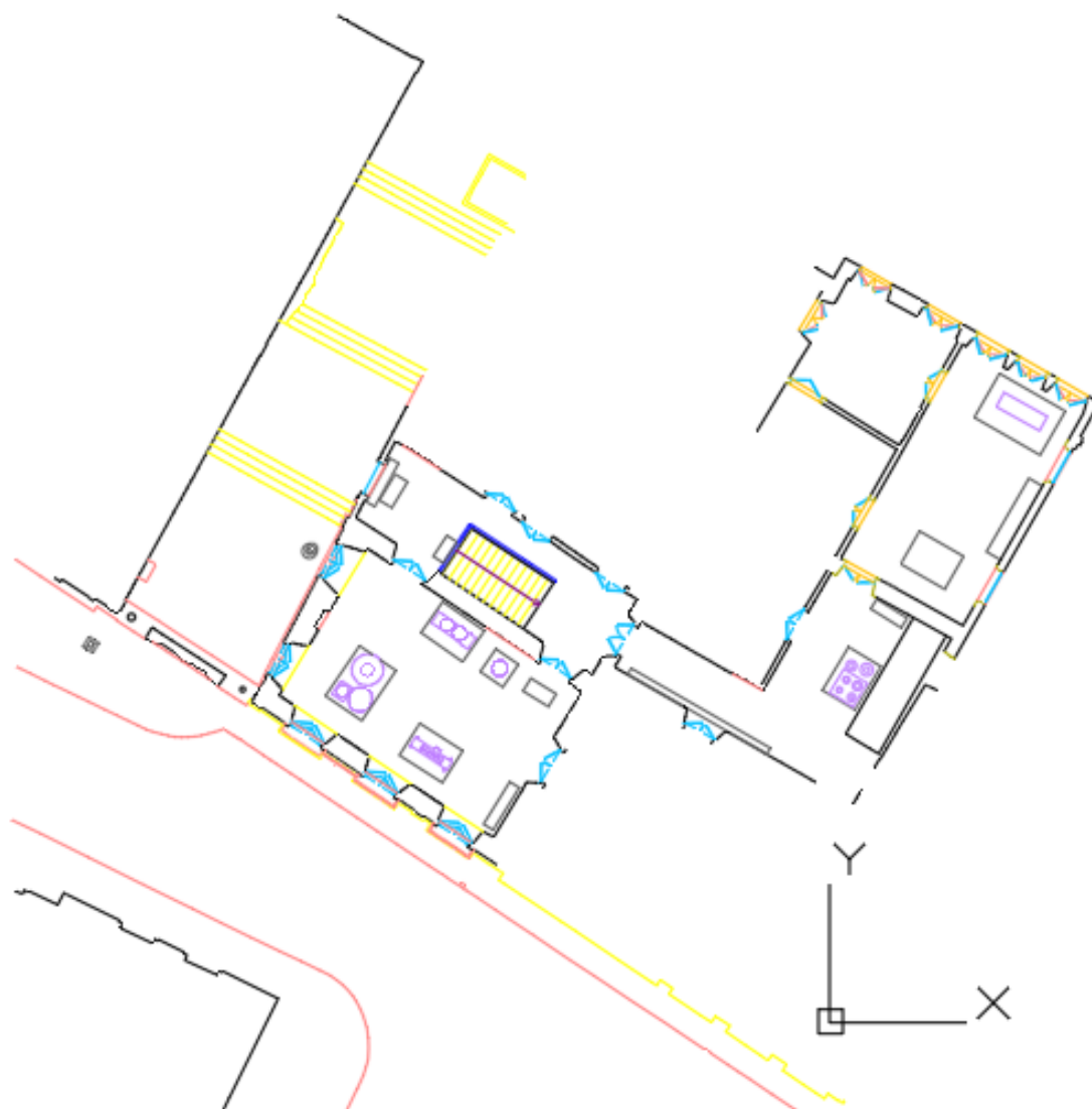
Figura 4.22 – Planta do térreo do Solar, desenhada a partir da nuvem de pontos com software CAD.
