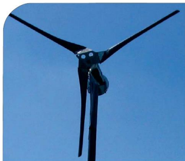
Figura 9 - Turbina Proven 15kW
