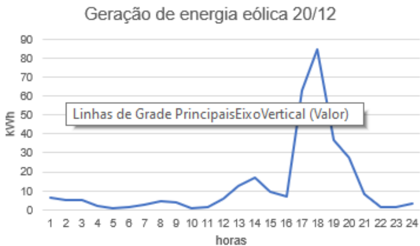
Figura 101 - Geração de energia eólica diária da turbina Proven 15 segundo simulação no EnergyPlus.
