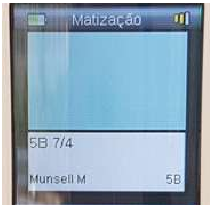
Figura 4 - Aparelho colorímetro utilizado para a medição de cor no sistema Munsell. Fonte: Autora (2020).
