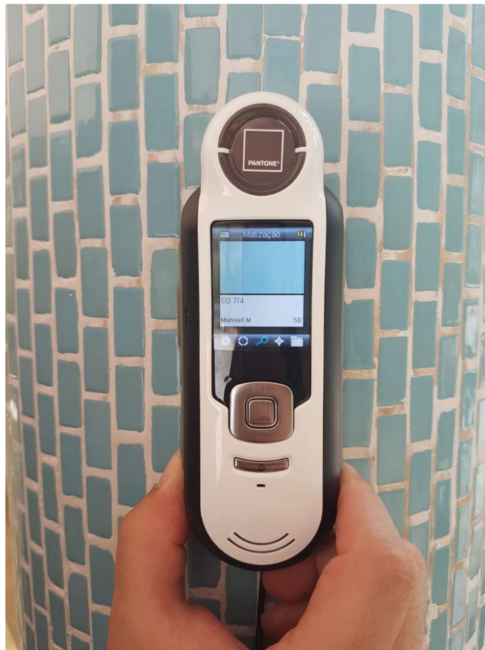
Figura 4 - Aparelho colorímetro utilizado para a medição de cor no sistema Munsell. Fonte: Autora (2020).
