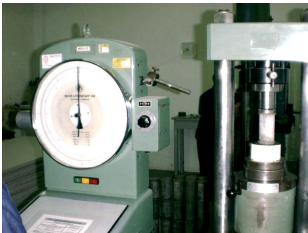
Figura 9.X - Máquina de ensaio – fabricante: Mohr & Federhaff – tipo: hidráulica a compressão – capacidade nominal: 20 toneladas
