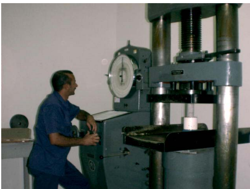
Figura 9. X - Máquina de ensaios à compressão – fabricante: Mohr e Federhaff AG – modelo: BPPS 200 – tipo: eletro-hidráulica – ano: 1969 – capacidade máxima: 200 toneladas
