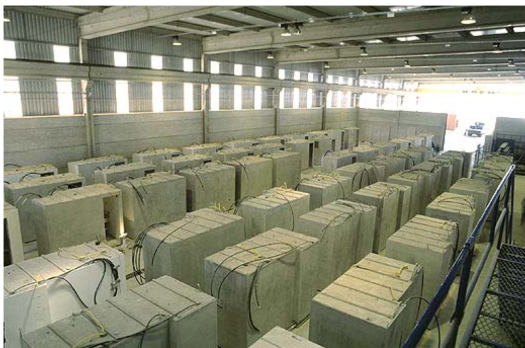
Figura 2.2 – Linhas de produção de banheiros prontos pré-fabricados em usina
