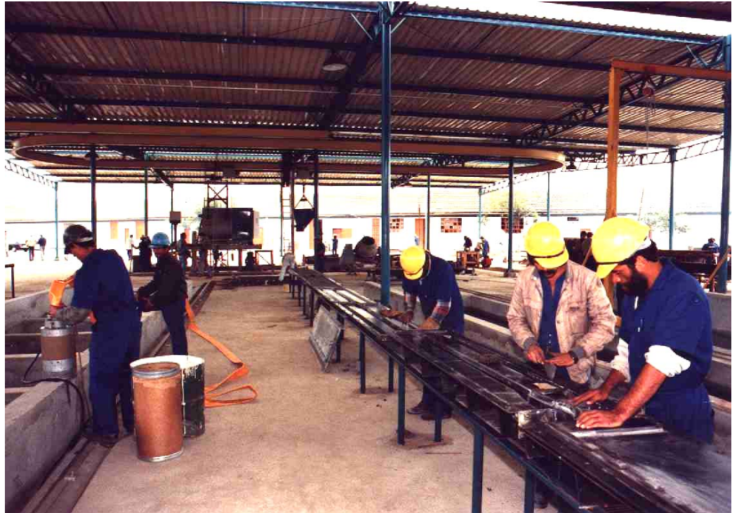
Figura 2.4 - Linhas de produção de componentes pré-fabricados leves para canalização de córregos em assentamentos precários – Centro de Desenvolvimento de Equipamentos Urbanos e Comunitários-CEDEC/EMURB (São Paulo, 1990)
