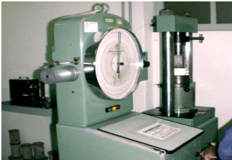
Figura 9.1 - Prensa hidráulica inicialmente usada para os ensaios à compressão, com capacidade nominal de 20 toneladas
