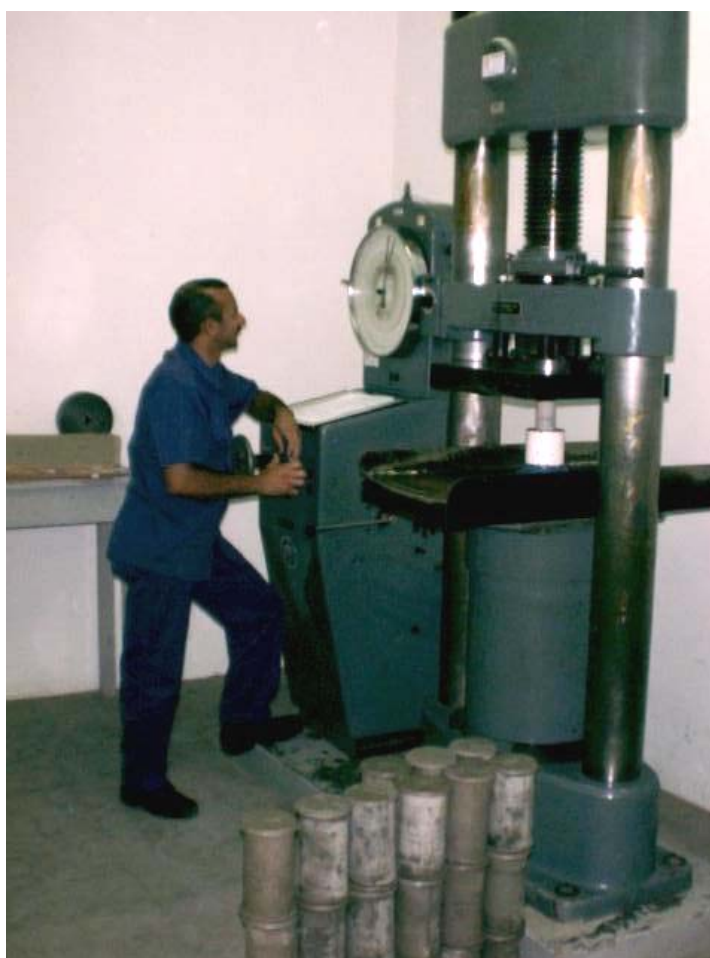
Figura 9.2 - Prensa eletro-hidráulica que passou a ser utilizada para os ensaios à compressão, com capacidade nominal de 200 toneladas
