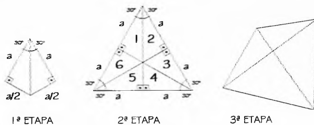
Fig. 4: Construção do tetraedro
