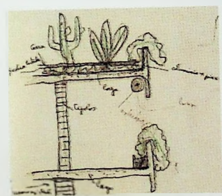
Fig. 17: Residência Mario Cravo, teto-jardim, lonas de enrolar
