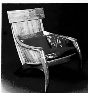
f.3.40. Cadeira Flexa. 1990. A Flexa é produzida de forma semi-industrial em mogno e amendoim maciço. Os arcos são executados em lâminas de mogno moldado a quente. Permite variações, aqui na versão "Flexa de Madeira", com assento em couro natural e laminado de mogno no encosto, e na versão "Flexa", com percintas de algodão colorido. (Arquivo Carlos Motta).
