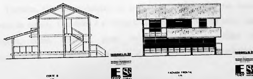
Figura 7.23 - Modelo SR2 de casa com planta H, corte transversal e fachada frontal, pertencentes ao catálogo de Sérgio Rodrigues. Arquivos do arquiteto.
