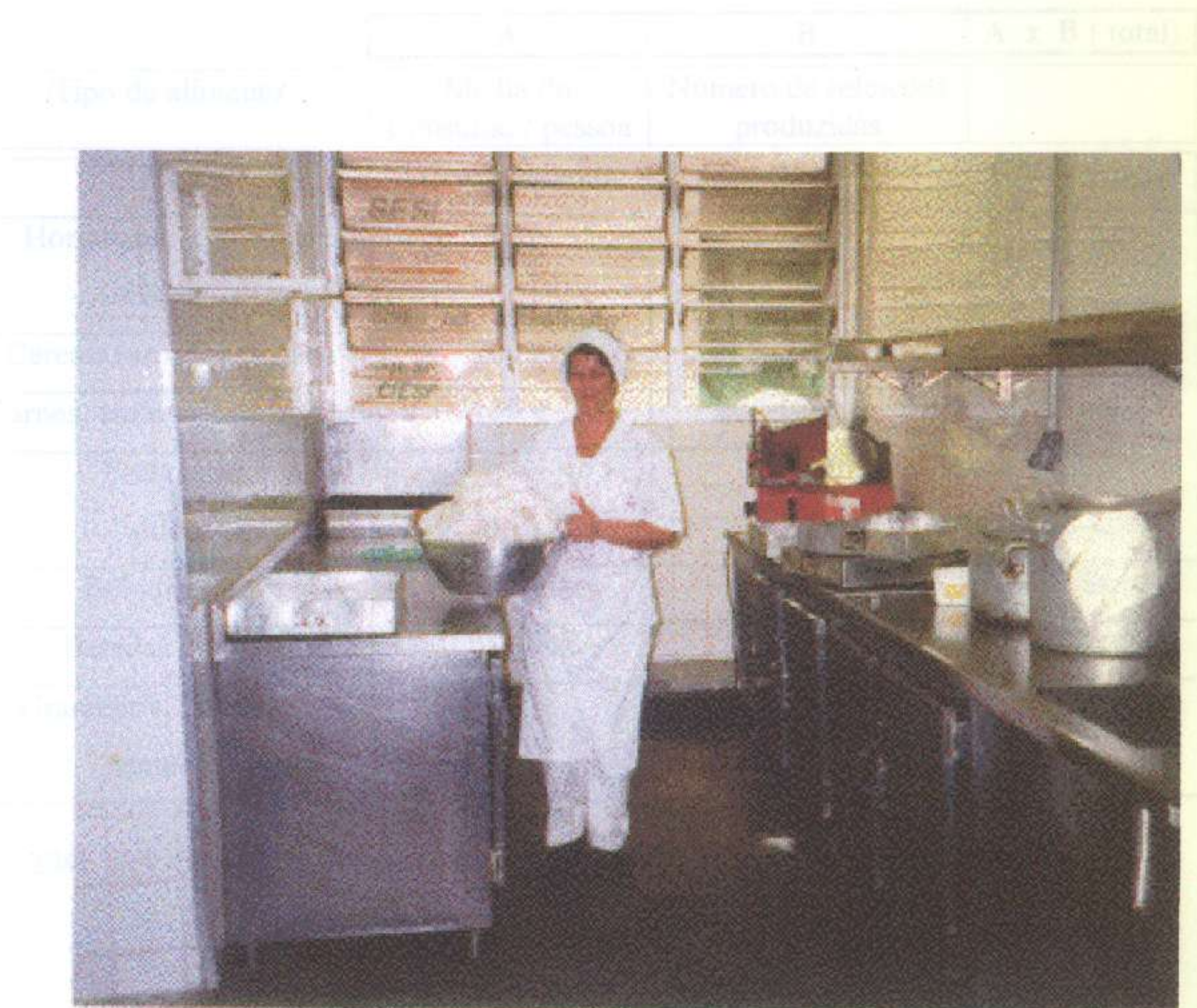
FIG. 114 - Observar o pouco espaço livre existente entre as duas bancadas. A largura deste "espaço livre" é insuficiente para dois operadores trabalharem simultaneamente. Verificar ainda a existência de portas sob as bancadas, as quais quando estão abertas dificultam a circulação e a realização dos trabalhos.
