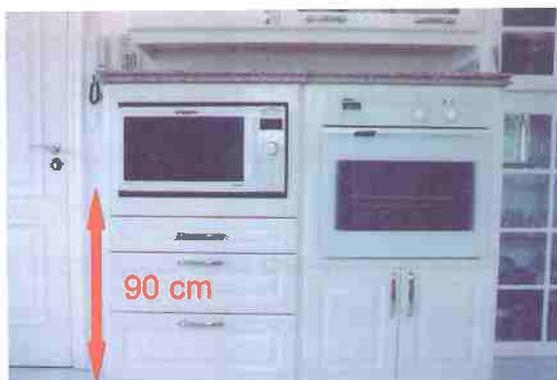
Figura 29: Microondas e forno em altura que não exige esforço para alcance e uso (90 cm).
