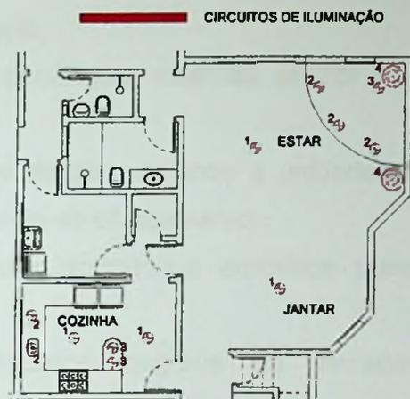
Figura 87. Planta dos pontos de luz e circuitos separados para controle da iluminação na cozinha e sala de estar
