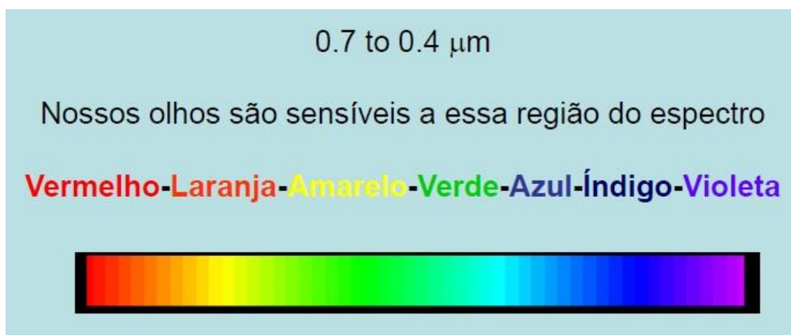
Figura. Os comprimentos de onda da luz visível. Vermelho corresponde a cerca de 0,7 \mu m e violeta a 0,4 \mu m .
