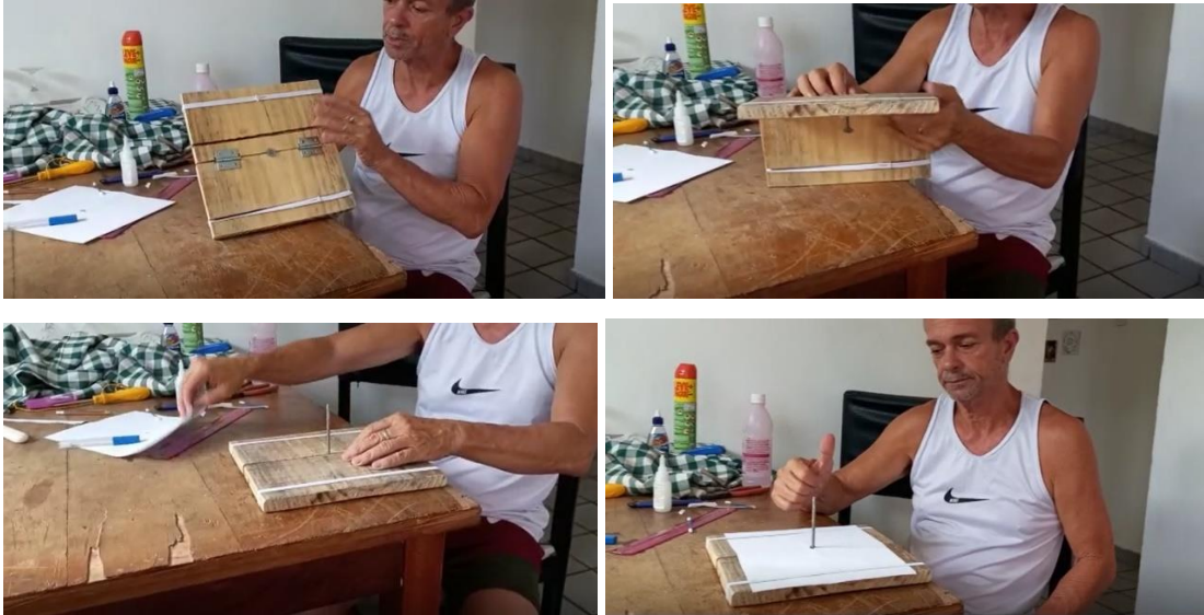
Figura 4.9. Etapas da montagem do gnômon portátil pelo artesão “Seu” Mário.
