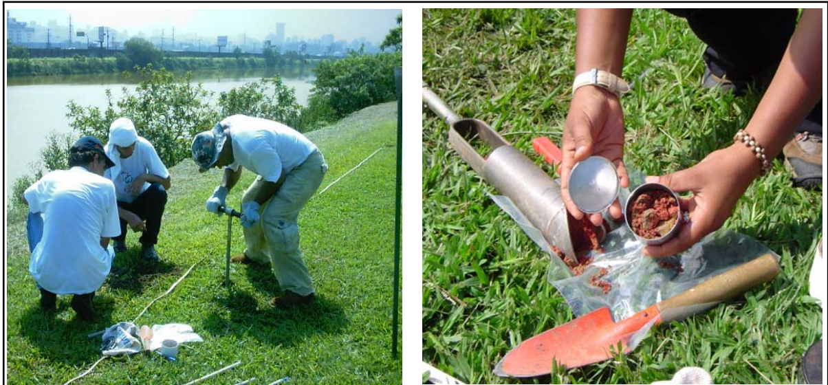
Figura 2.1 – Amostras do solo sendo coletadas na linha geofísica e colocadas em recipientes adequados
