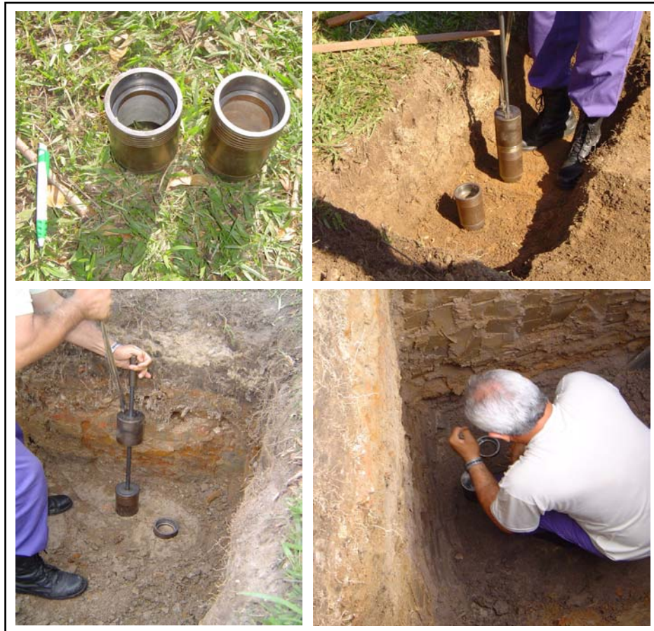
Figura 2.3 – Amostrador Uhland e coleta de amostras indeformadas em vários horizontes para obtenção do teor de umidade volumétrico
