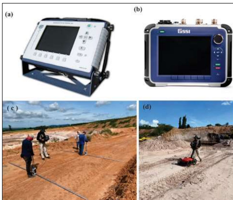
Figura 4.3 – (a) SIR 3000 usado com a antena de 270 MHz; (b) antena MLF de 40 MHz; (c) SIR 4000 usado com a antena de 270 MHz; (d) antena de 270 MHz. Fonte: (a) e (b) GSSI ( www.geophysical.com ), (c) e (d) autor.
