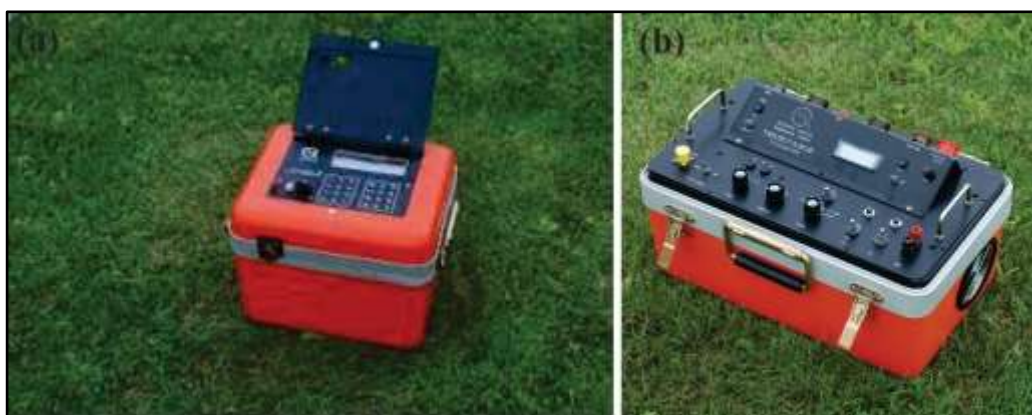
Figura 4.4 – Receptor Protem-D; transmissor TEM 57–MK2. Fonte: Geonics (2023).
