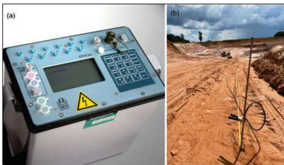
Figura 4.2 – (a) Syscal Pro utilizado na pesquisa de campo; (b) eletrodo metálico. Fonte: (a) Iris Instrument; (b) autor.
