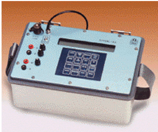
Figura 3.6 - Equipamento para ensaios de resistividade Iris Syscal R2.
