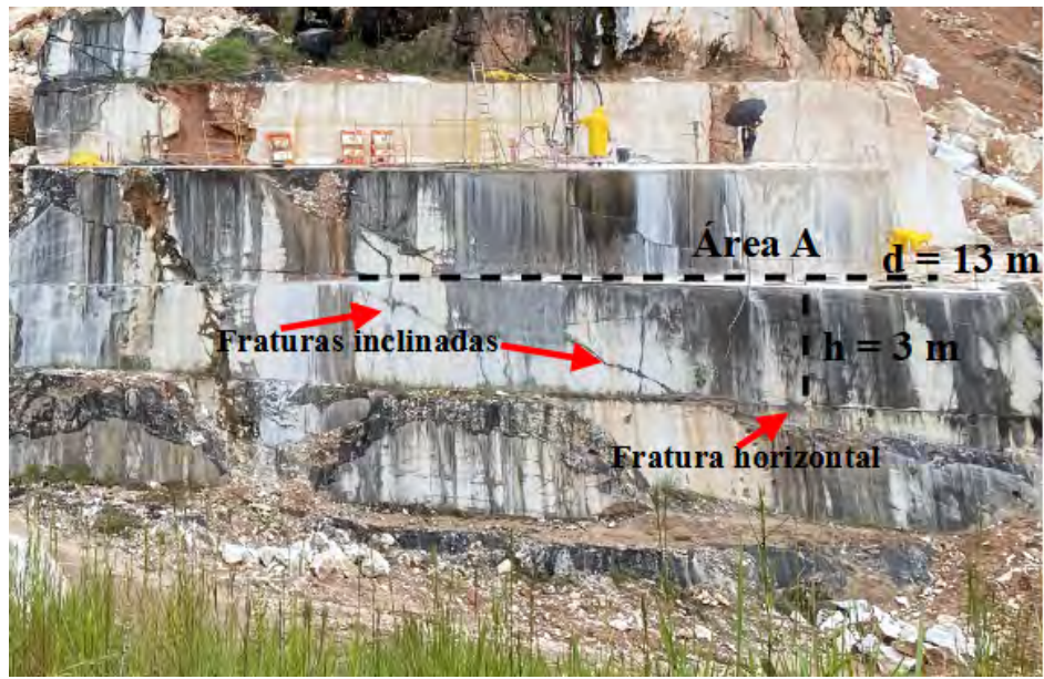
Figura 6.25. Fotografia da frente de lavra da pedreira ativa. Na imagem, é possível visualizar parcialmente a bancada de mármore que compreende a Área A.
