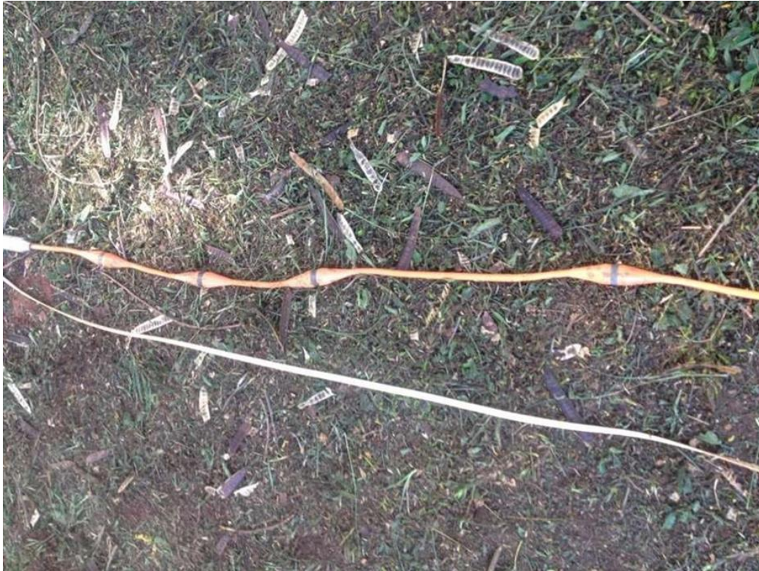
Figura 4.2 – Sonda OYO (laranja) adaptada para realizar as medidas de potencial espontâneo com dois espaçamentos distintos: 50 e 100 cm entre os eletrodos, referidos como curto e longo, respectivamente.
