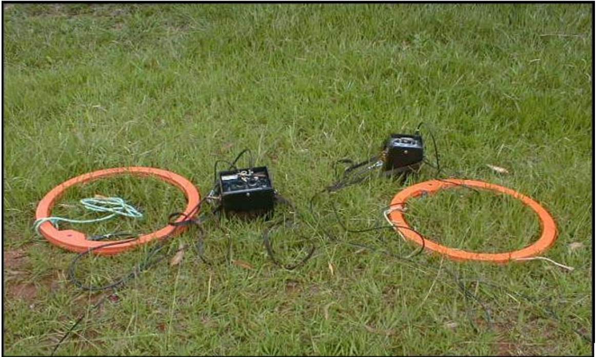
Figura 22 – Equipamento EM-34 da empresa canadense Geonics. Bobina transmissora T_x à esquerda e bobina receptora R_x à direita (SOUZA, 2007).
