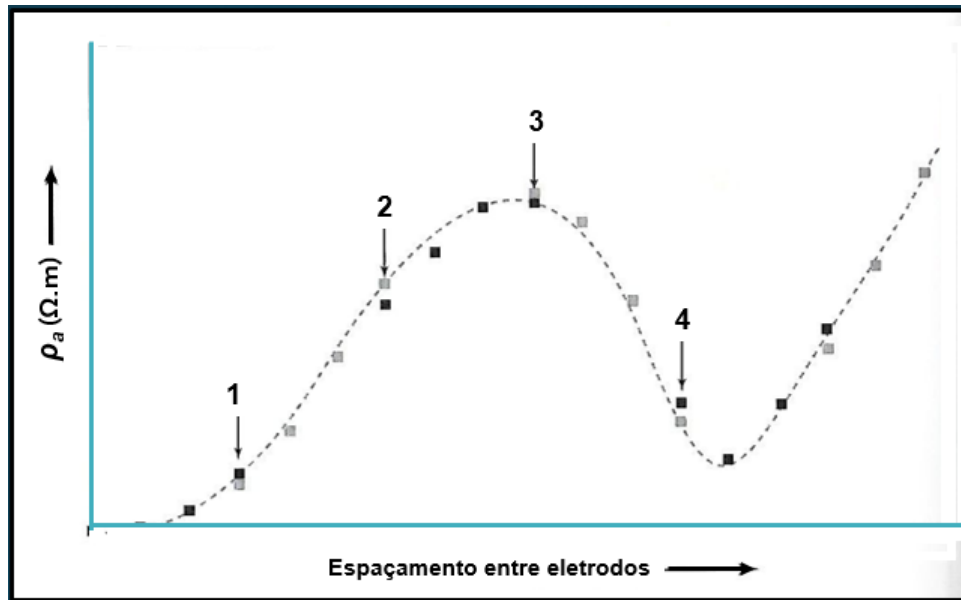
Figura 10 – Manobra de embreagem (aumento da distância entre os eletrodos de potencial MN para uma mesma abertura AB) realizada nos pontos 1, 2, 3 e 4, em um levantamento eletrorresistivo pontual pelo arranjo Schlumberger. (adaptado de BURGER et. al. 1992).
