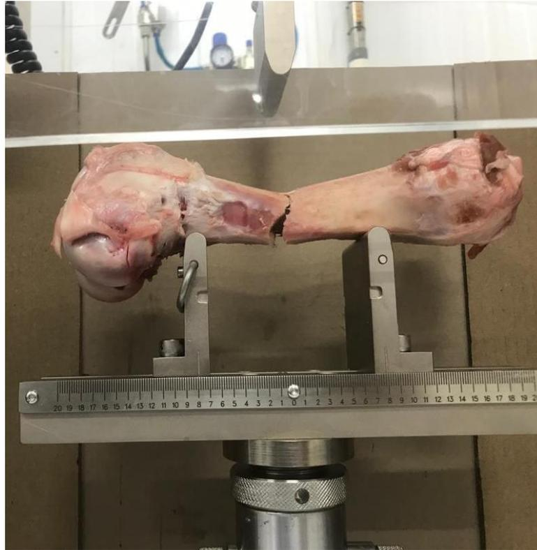
**Figura 4.** Osso fêmur de suíno rompido após o teste de flexão
