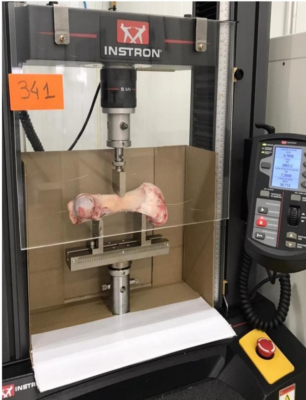
**Figura 3.** Equipamento para teste de força de flexão do osso fêmur de suíno
