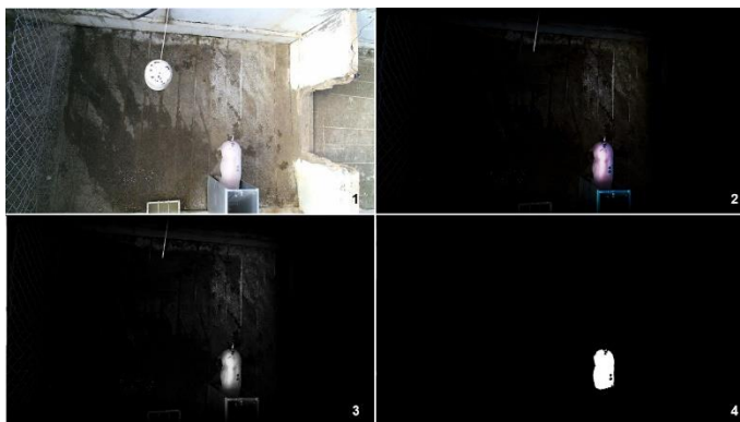
Figura 2 - 1. A imagem original captada pela câmera Kinect. 2. Imagem após edição para diferenciação do animal do fundo da imagem. 3. Imagem em escala de cinza no início da análise pelo MATLAB®. 4. Imagem binária para a detecção da área do animal.
