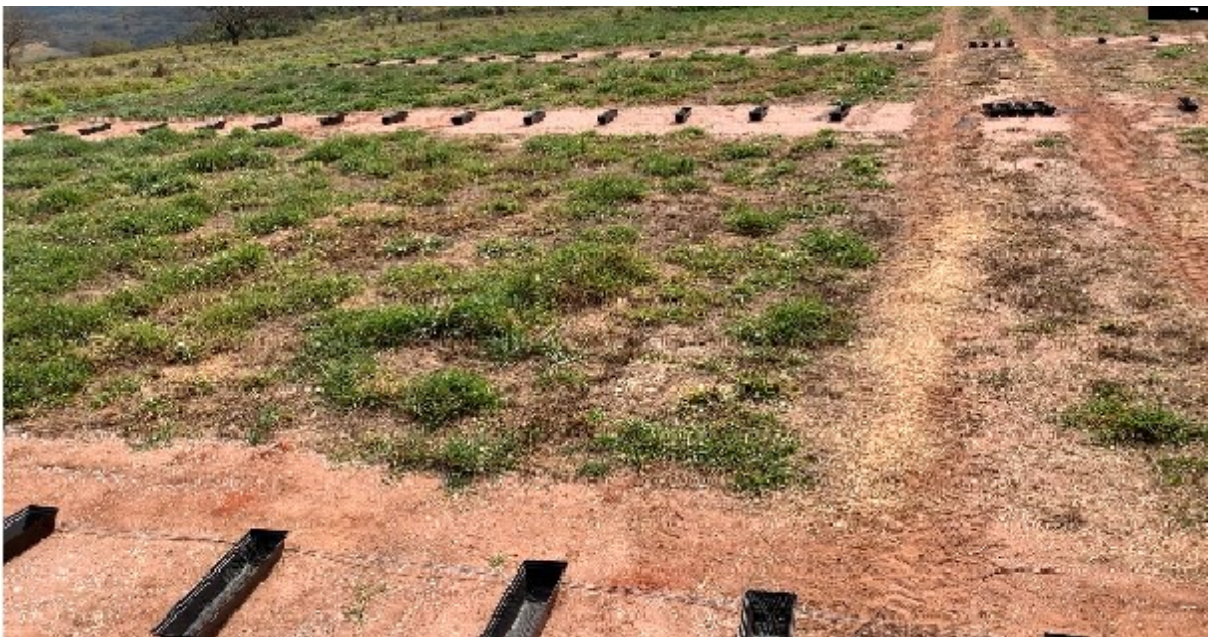
Figura 20: Campo experimental instalado para as coletas de material durante os testes de uniformidade de distribuição.
