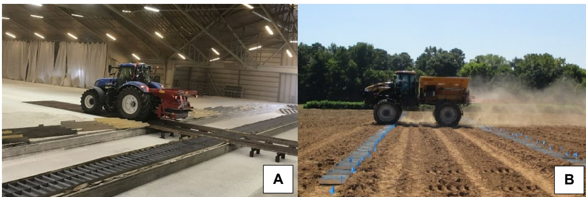
Figura 4: Exemplos do ensaio normalizado para caracterização do perfil transversal de distribuição. A) Ensaio em ambiente fechado e com sistemas de pesagem automática dos coletores. B) Ensaio em campo aberto realizado com aparato experimental tradicional. Fonte: A) Danish Technological Institute (DTI). B) Colley et al, 2018.
