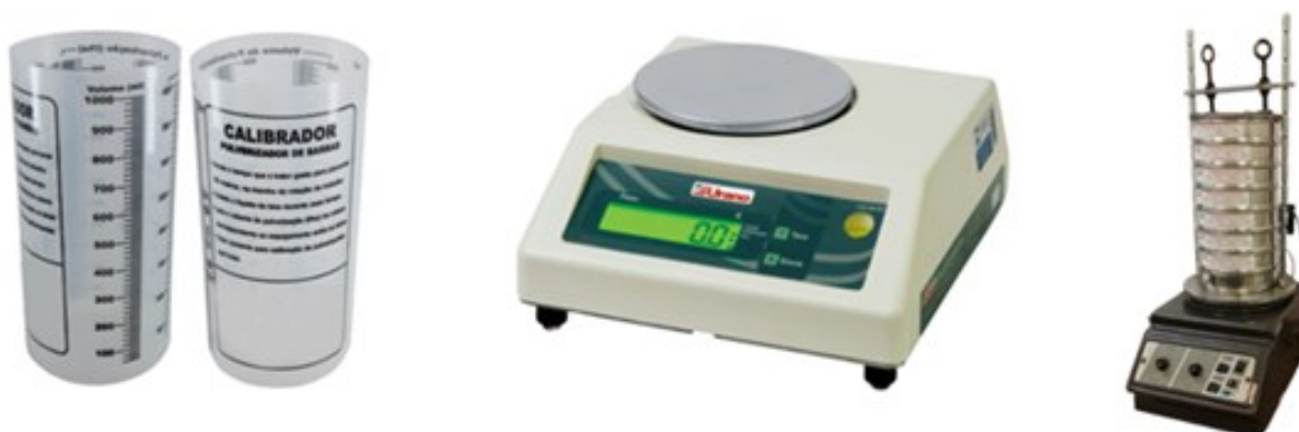
Figura 14: Copo calibrador de volume 1 L, balança digital com precisão de 0,01 g, agitador mecânico e conjunto de peneiras.
