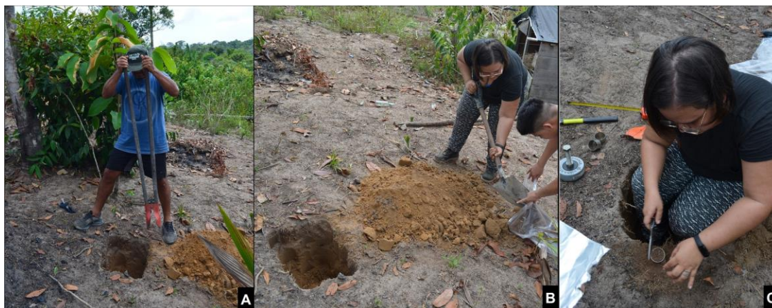
Figura 10. Etapas da coleta de solo na Flona do Pau-Rosa, nas margens da região populamente conhecida como “Salto do Amana”: (A) abertura do perfil de solo para a coleta das amostras deformadas com o auxílio de uma boca de lobo; (B) coleta das amostras e sacos plásticos com o auxílio de uma pá e, (C) coleta das amostras indeformadas com os anéis metálicos.
