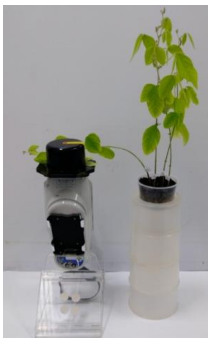
Figura 2. Aparato para otimização do tempo com XRF portátil da folha in vivo
