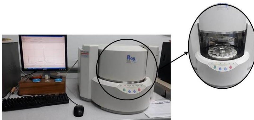
Figura 19. Equipamento XRF de bancada Shimadzu.
