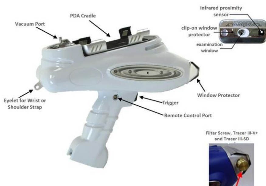
Figura 1. XRF portátil Tracer III-SD Bruker e seus componentes, adaptado de User Guide Bruker
