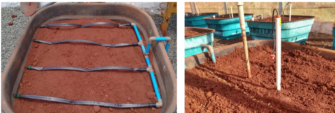
Figura 5. Instalação das mangueiras gotejadoras (A) e do tensiômetro e extrator de solução (B) na parcela experimental.
