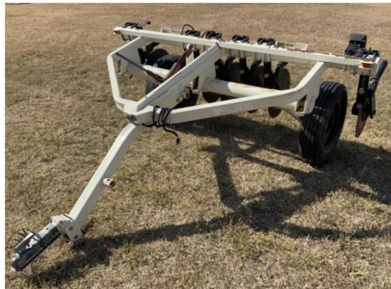
**Figura 1.** Veris 3100 com arranjo de seis eletrodos.
