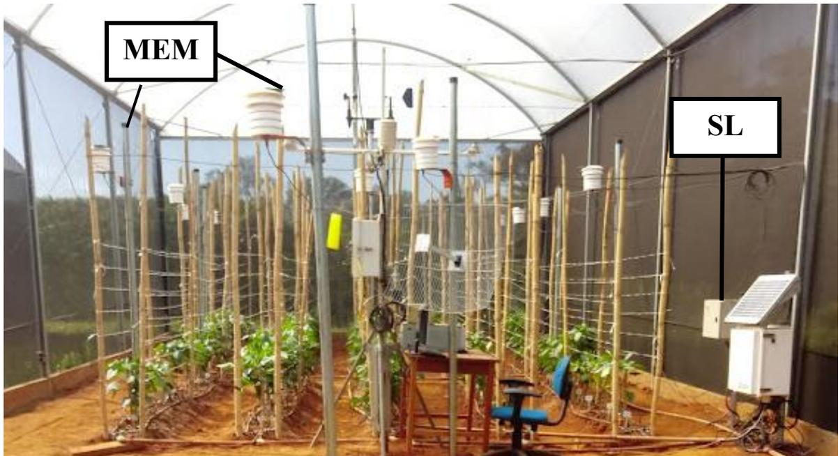
Figura 1. Equipamentos do sistema de manejo via inteligência artificial instalados na casa de vegetação: micro estação meteorológica (MEM ) e servidor local (SL) .
