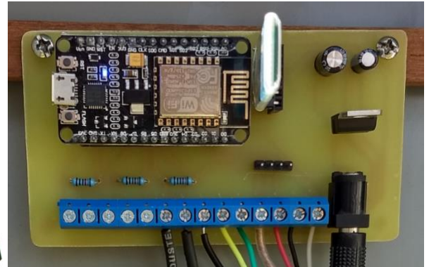
Figura 29. Dispositivo datalogger da estação. A – Vista modelada; B – Controlador instalado.
