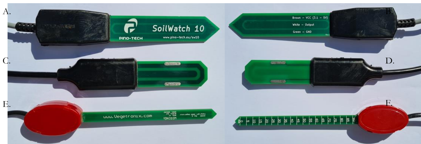
Figura 78. Sensores SoilWatch 10, PM WCS 3 e VH400, análise visual pós teste de calibração, sendo: A – SoilWatch 10 em vista superior; B – SoilWatch 10 em vista inferior; C – PM WCS 3 em vista superior; D – PM WCS 3 em vista inferior; E – VH400 em vista superior; F – VH400 em vista inferior.
