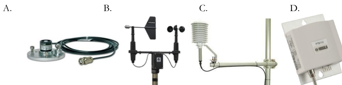
Figura 15. Sensores presentes na estação. A – Piranômetro LI 200 X; B – Anemômetro 03002 Campbell; C – HMP45C; D – Vaisala CS 106.
