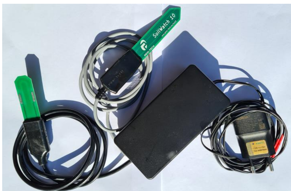
Figura 81. Dispositivo final para coleta dos dados em campo, com alimentação via fonte, com entrada para sensores com comunicação I2C e analógica.
