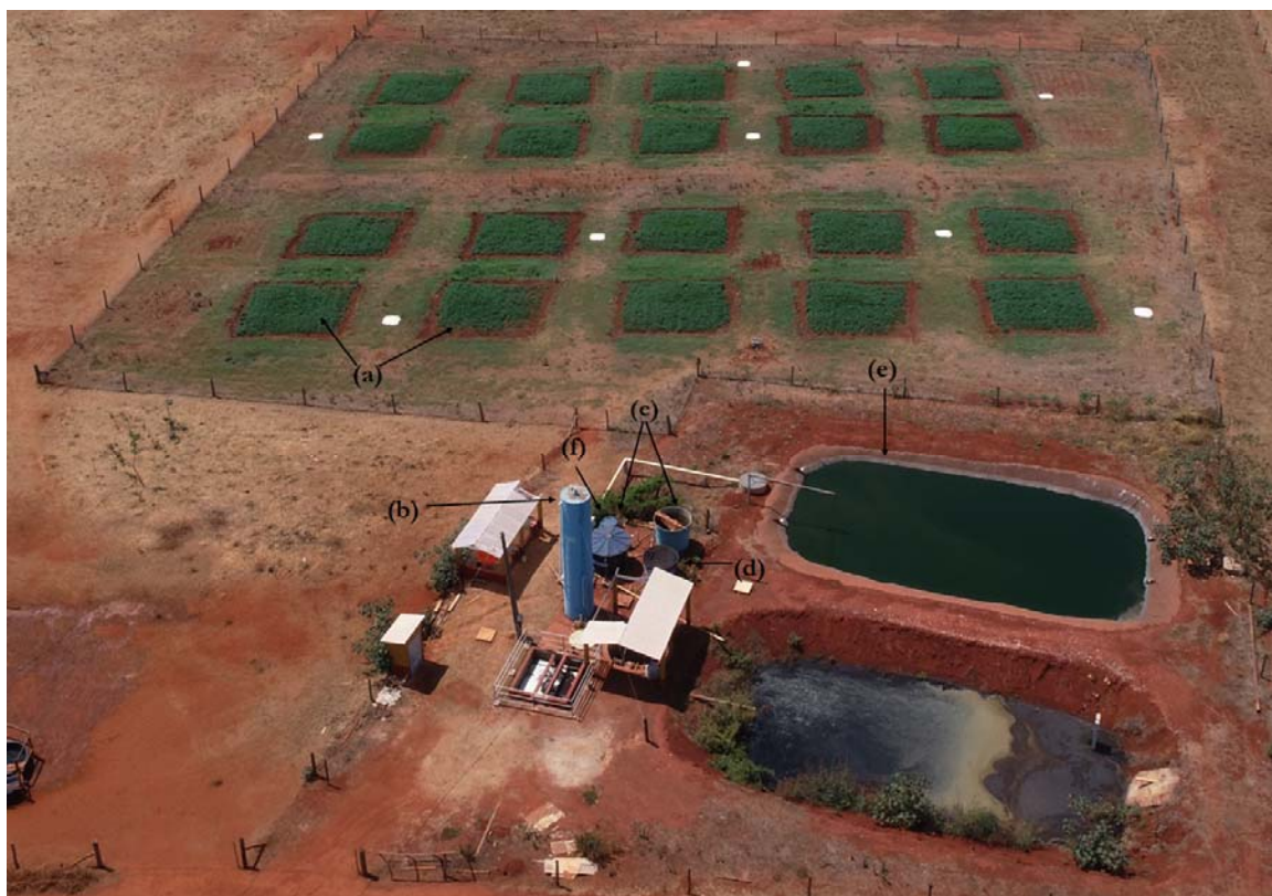
Figura 9. Área experimental campus Fernando Costa. (a) Parcelas experimentais; (b) Reator UASB; (c) Caixas de armazenamento de efluente; (d) Caixa de armazenamento de água; (e) Lagoa de efluente tratado de abatedouro e (f) Controladores do sistema de irrigação. Fonte: própria autoria.
