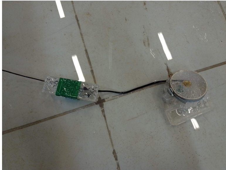
Figura 28: Detalhamento do sensor, recebendo água (parte circular), a parte retangular é somente uma emenda de fio, protegida por uma caixa de acrílico.
