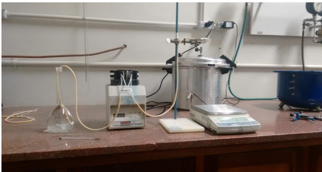
Figura 13: Posicionamento dos equipamentos no primeiro teste, situados em primeiro plano na foto, da esquerda para a direita: balão volumétrico, bomba peristáltica, suporte universal e balança de precisão.
