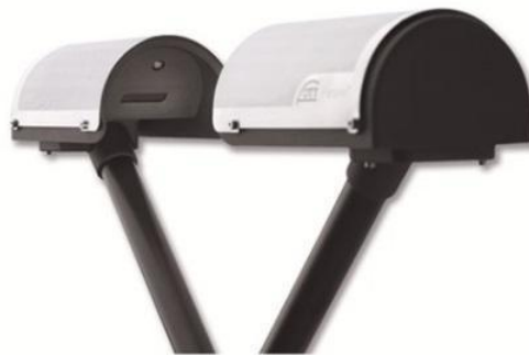
Figura 4: Disdrômetro a laser OTT Parsivel.
