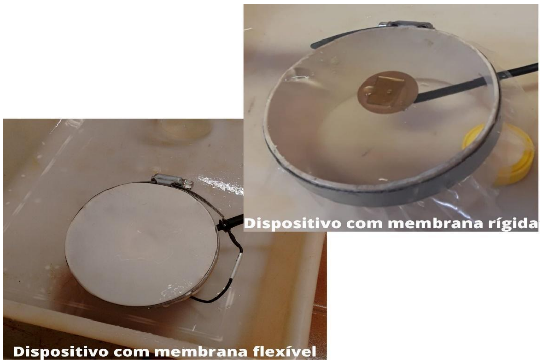
Figura 17. Diferenças entre a membrana flexível (látex) e a rígida (polietileno de baixa densidade).
