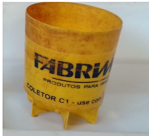
Figura 20: Coletor utilizado para os testes, fabricado pela Fabrimar. O esquema da montagem dessa linha é mostrado na Figura 21:
