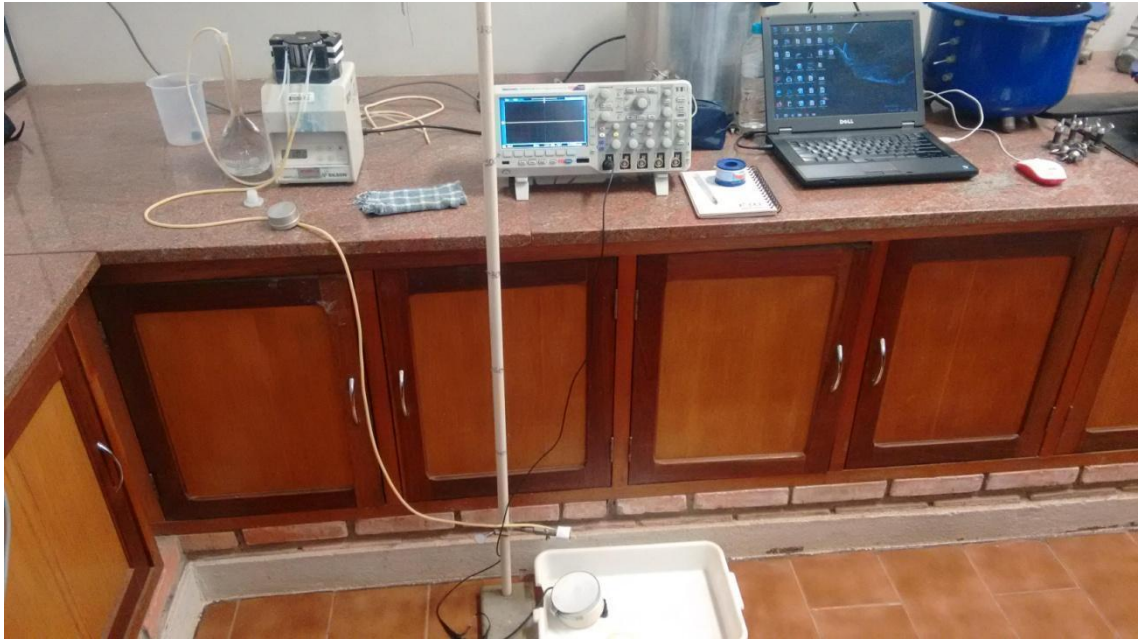
Figura 16. Posicionamento dos equipamentos no segundo teste. Na figura consta; na esquerda para direita, com balão volumétrico, bomba peristáltica, osciloscópio, suporte universal com variação de altura e dispositivo de membrana . Ignorar a panela de pressão.
