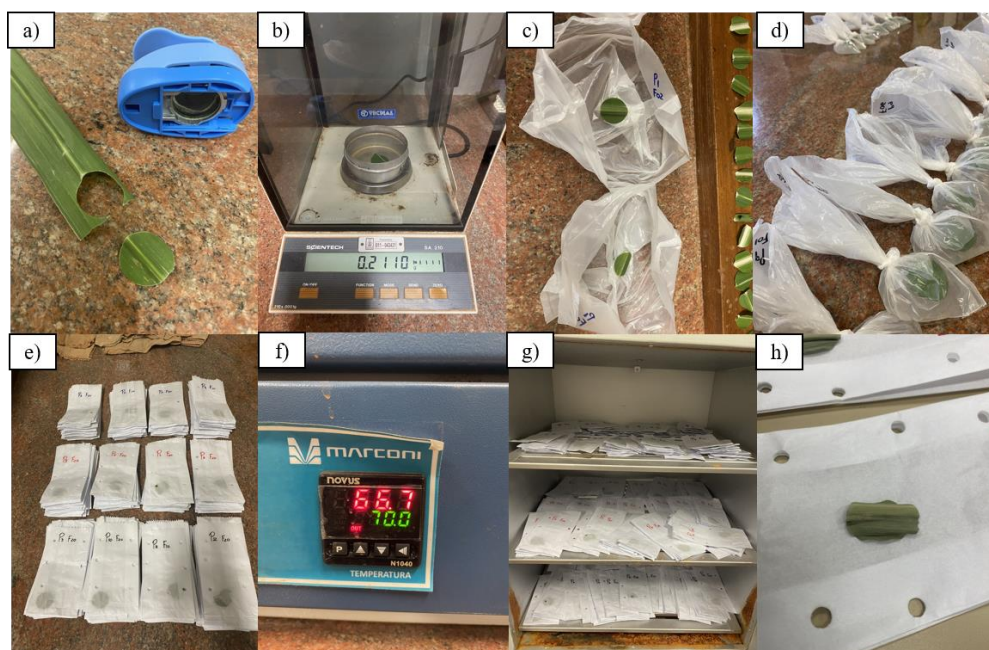
Figura 9. Folha cortada com a ajuda de um furador tipo scrapbook circular de 25mm de diâmetro (a); balança de precisão utilizada nas pesagens (b); separação dos sacos plásticos para iniciar a etapa da medição do peso túrgido (c); amostras submersas em água destilada (d); amostras armazenadas em sacos furados prontas para secagem (e); temperatura da estufa a 70 C° (f); disposição das amostras dentro da estufa (g); folha seca após 72h (h)
