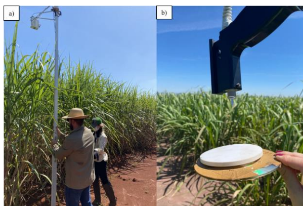
Figura 8. Obtenção das curvas espectrais do dossel com o espectrorradiômetro HandHeld 2 acoplado em uma régua (a); placa branca de sulfato de bário ( \text{BaSO}_4 ) para calibração do sensor (b)
