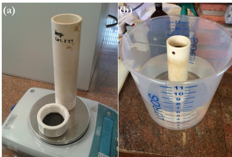
Figura 3: Montagem e pesagem do conjunto das colunas (a) e Saturação das colunas com água deionizada (b).
