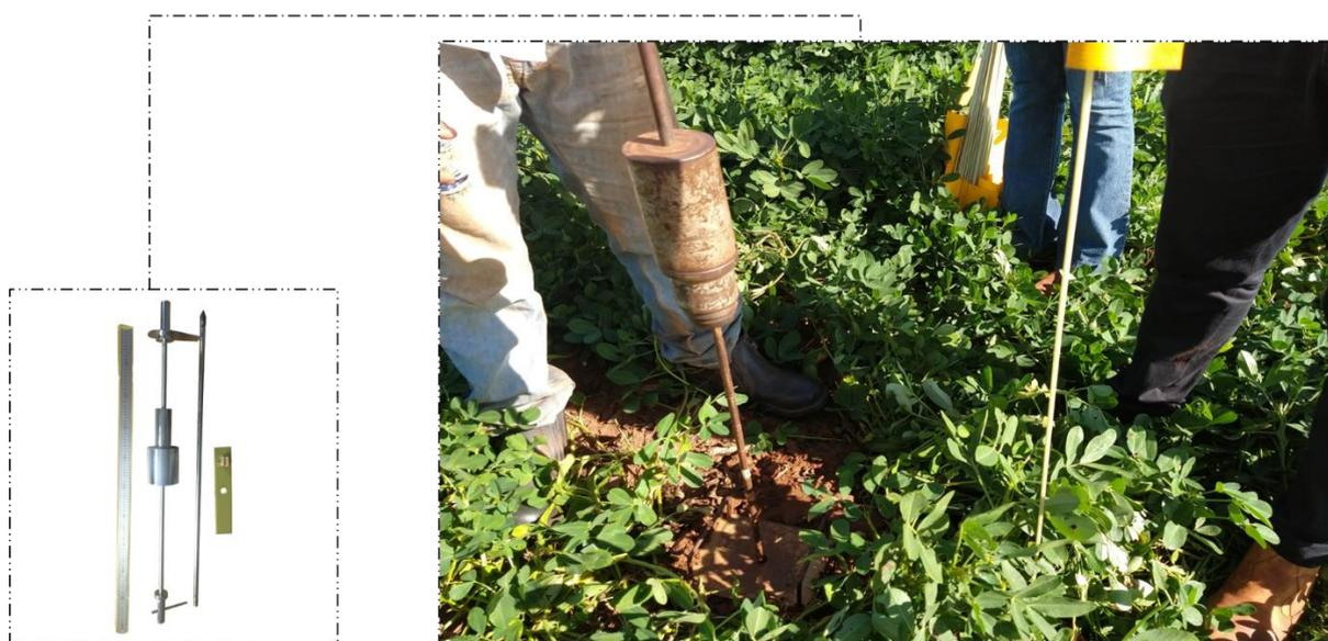
**Figura 5.** Determinação da resistência mecânica do solo à penetração com penetrômetro de impacto.
