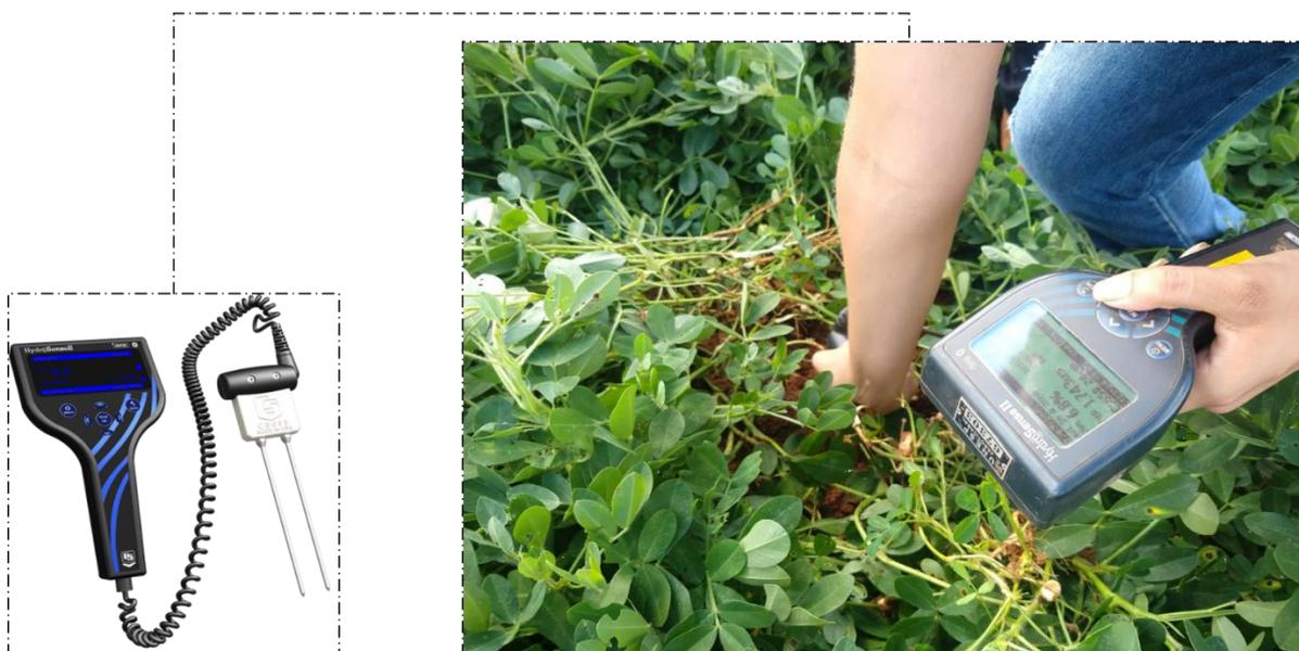
**Figura 4.** Determinação do teor de água no solo utilizando uma sonda TDR (Time Domain Reflectometer).
